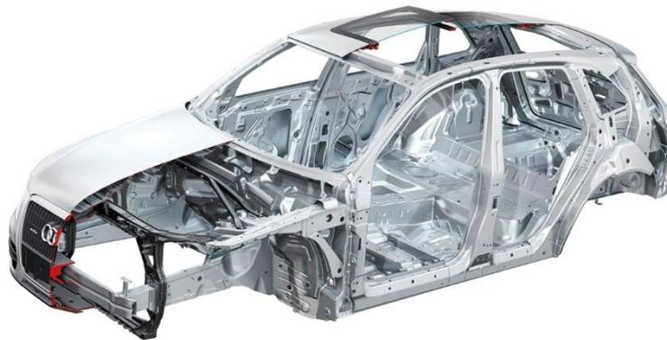
*Ilustración 9 -Ejemplo Chasis autoportante*
