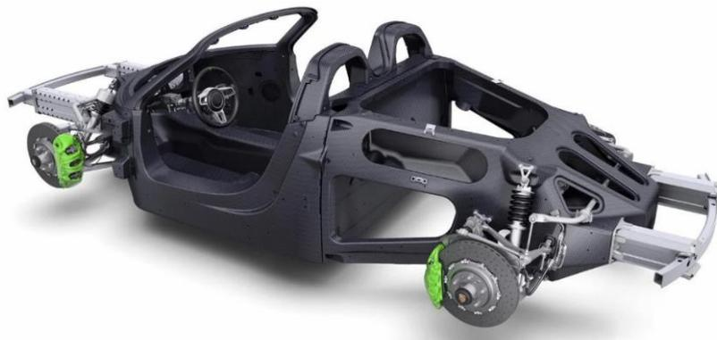
*Ilustración 24 -Chasis de fibra de carbono.*
