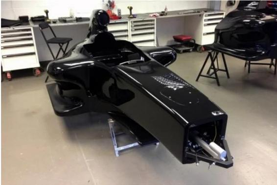
*Ilustración 14 -Chasis monocasco de fibra de carbono*
