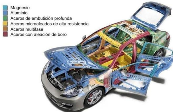
*Ilustración 6 -Distribución de materiales en función de la zona del vehículo*
