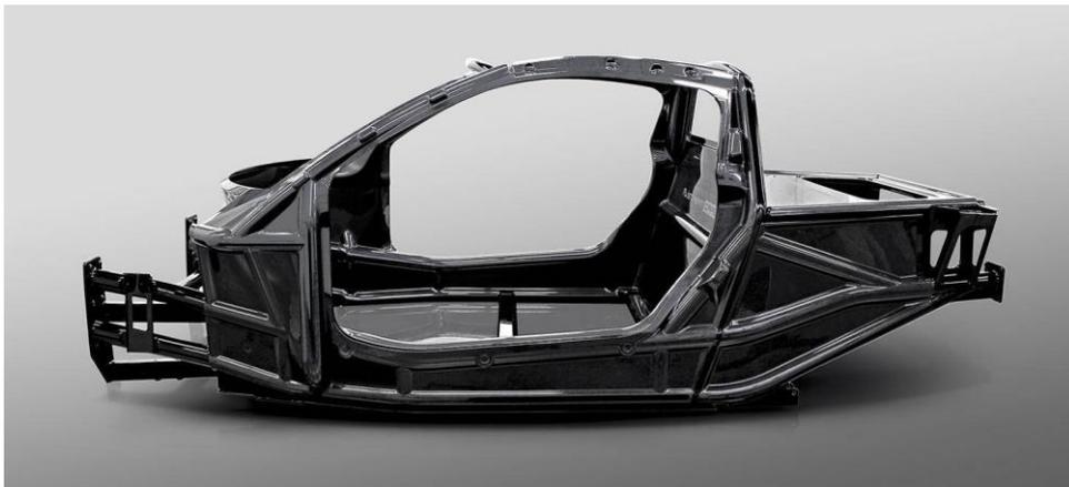
*Ilustración 11 -Chasis monocasco de fibra de carbono*
