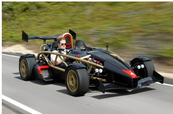
*Ilustración 23 -Vehículo con chasis tubular*
