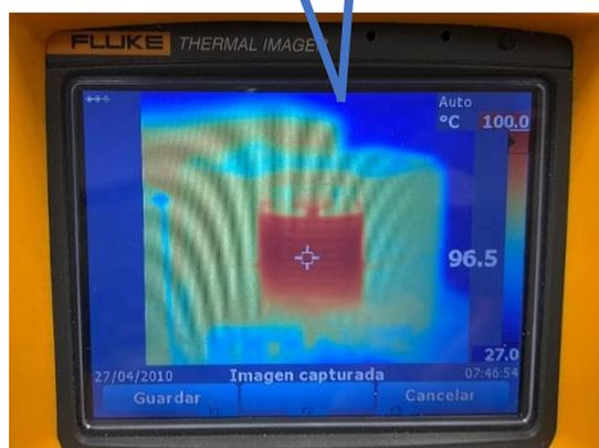
Ilustración 23. Temperatura de las bobinas 1 y 4 medidas con la cámara térmica.
