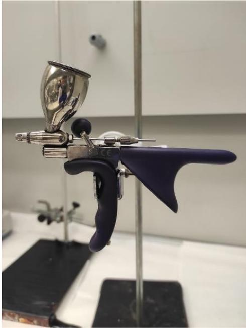
Figura 6 Aerógrafo pulverizador.
