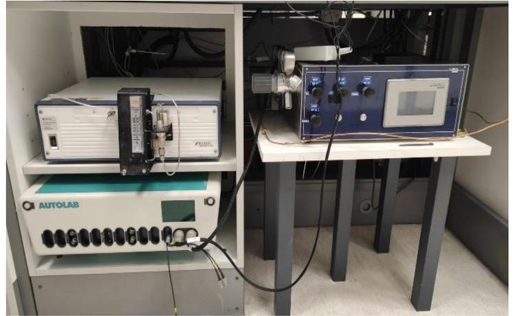
Figura 15 Microcromatógrafo de gas en línea Micro GC Inficon.
