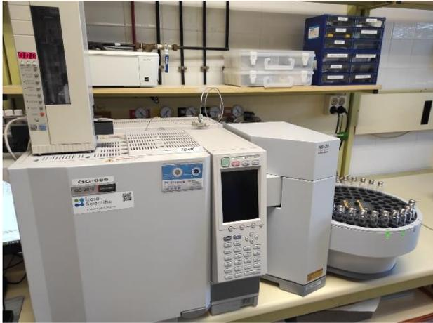
Figura 14 Cromatógrafo de gases GCMSQP210 Ultra Shimadzu.
