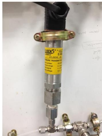
**Figura 2.16.** Transductor de presión
