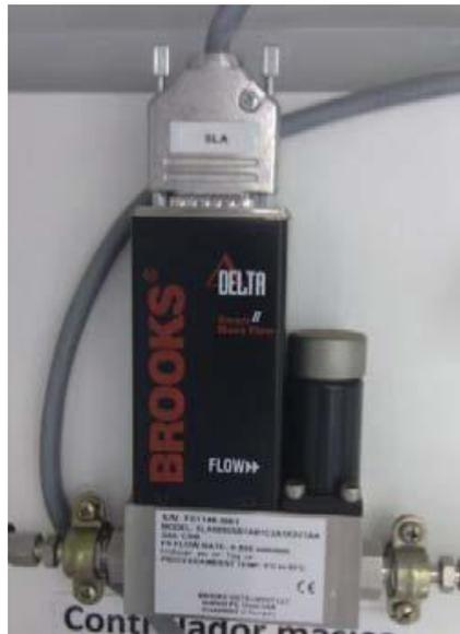
**Figura 2.12.** Caudalímetro/controlador máxico.
