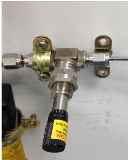
**Figura 2.17.** *Válvula micrométrica.*
