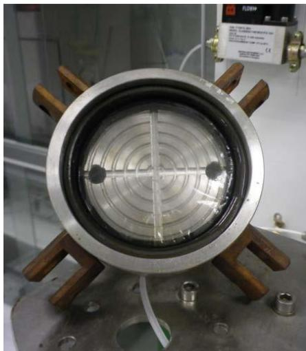
**Figura 2.22.** Fotografía de la celda con una membrana acoplada.
