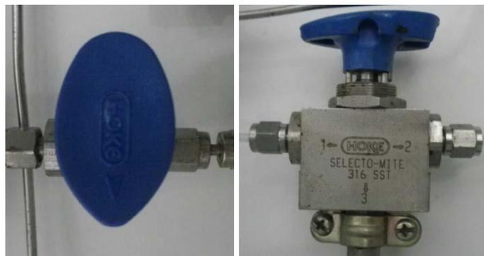
**Figura 2.13.** Válvulas de dos (3) y de tres vías (4).
