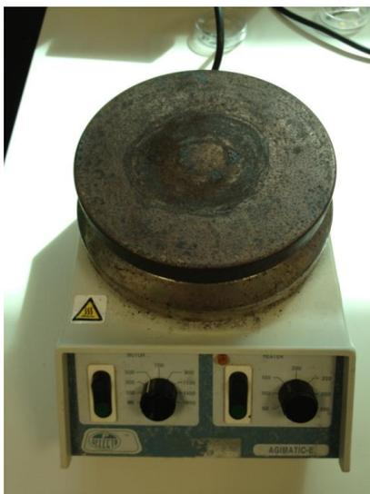
**Figura 2.3.** Placa Calefactora
