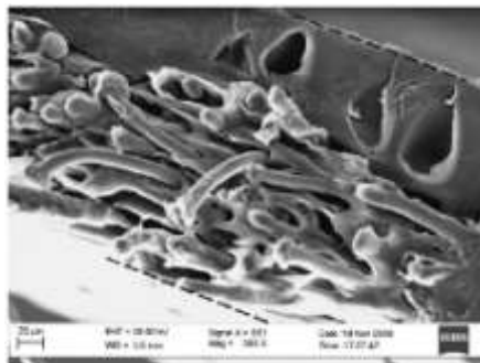
Figura 15. HTI OsMem CTA-NW. Imagen SEM corte transversal de la membrana. [31]
