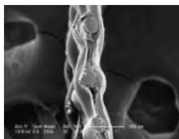
Figura 10. Corte transversal con microscopio electrónico de la membrana de menor espesor de ósmosis directa de HTI.
