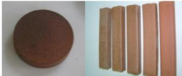
**Figura 17. Piezas sedimento/arcilla prensadas y extruidas**
