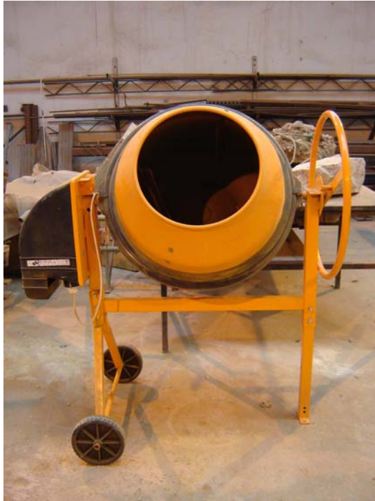
Figura 2.1: Hormigonera vertical con capacidad máxima de 80 kg.
