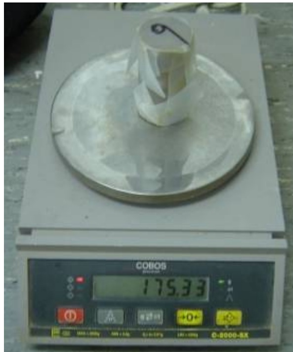
Figura 3.20: Probeta de compresión simple con su correspondiente protección con PARAFILM M® alrededor de ella.
