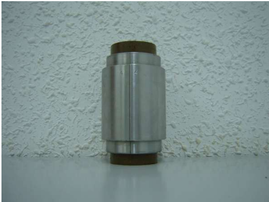
Figura 2.9: Probeta recién compactada, inmediatamente después de quitar los moldes metálicos extremos, con el molde central de 7,62 cm de altura.
