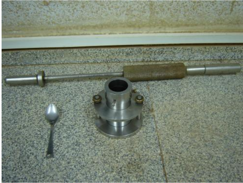
Figura 2.5: Masa Army y molde Harvard empleados en la fabricación de las probetas.
