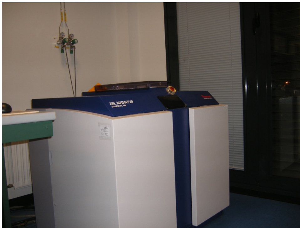
Figura 2.12: Espectrómetro para la determinación de la fluorescencia de rayos X.
