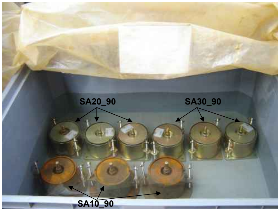
Figura 2.3: Probetas compactadas de CBR de las mezclas SA sumergidas para ser ensayadas a 90 días.
