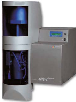
Figura 2.17: TG-DSC marca SETARAM modelo SETSYS-1700 empleado en la presente investigación.
