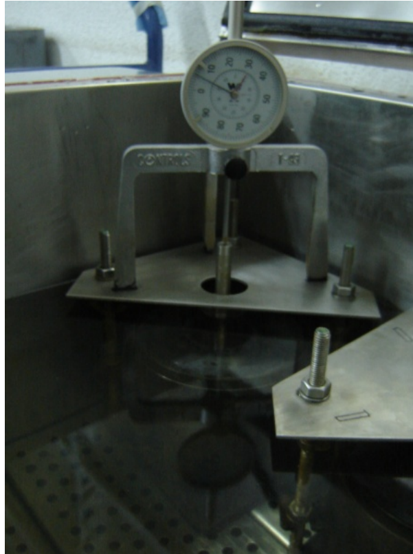
Figura 2.10: Procedimiento de lectura con deformímetro durante el ensayo de expansión potencial.
