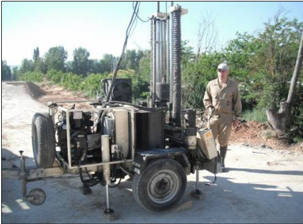
Figura 4.59: Penetrómetro marca “SUNDA” ubicado en la coronación del terraplén de suelo-escoria durante la realización del ensayo de penetración dinámica DPSH.
