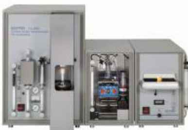
Figura 2.13: Analizador ELTRA modelo CS – 2000 para la determinación del contenido total de carbono y azufre.
