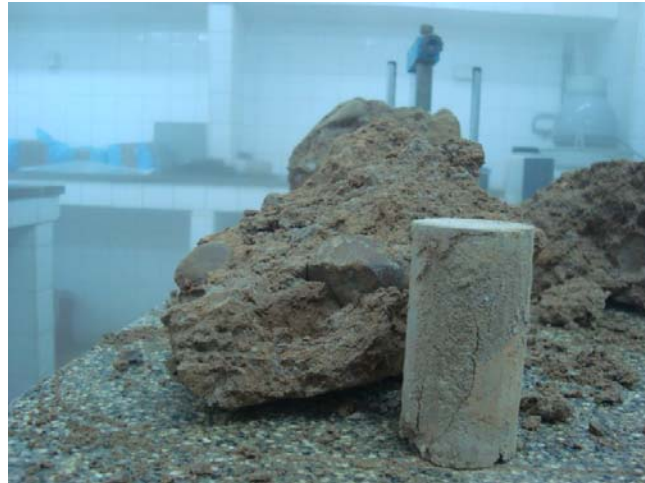
Figura 4.29: Grava encontrada en una muestra recogida del terraplén de suelo-escoria en contraste con una probeta de compresión simple tallada sobre un bloque procedente del terraplén suelo-cal.
