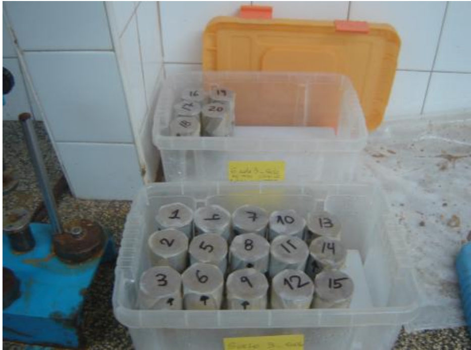
Figura 2.4: Almacenamiento y protección superficial del perímetro de 20 probetas para evitar la evaporación del agua de amasado.
