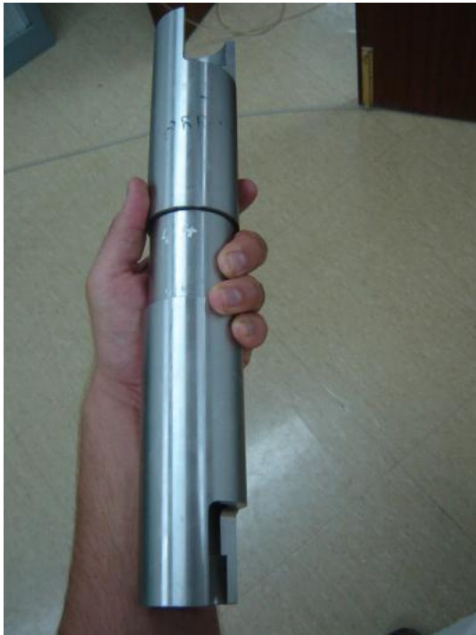
Figura 2.6: Molde empleado en la compactación estática de probetas.
