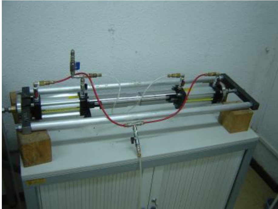
Figura 2.8: Disposición del sistema estático de compactación antes de proceder a la fabricación de una probeta.
