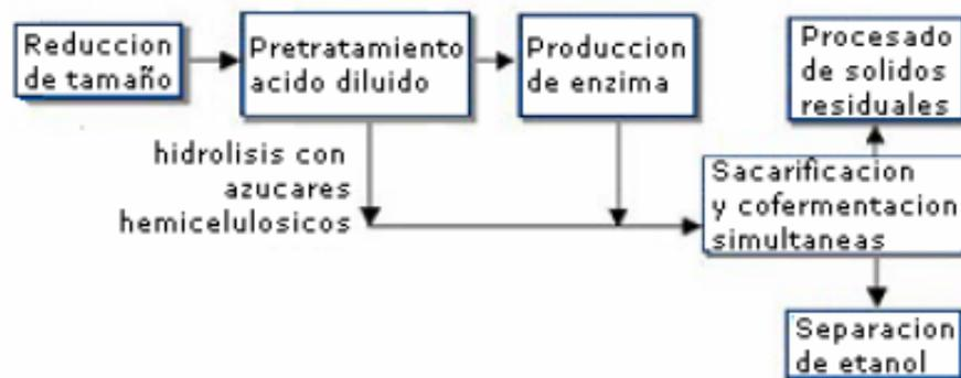
**Figura 21. Configuración del proceso enzimático para sacarificación y cofermentación simultáneas (SSCF)**
