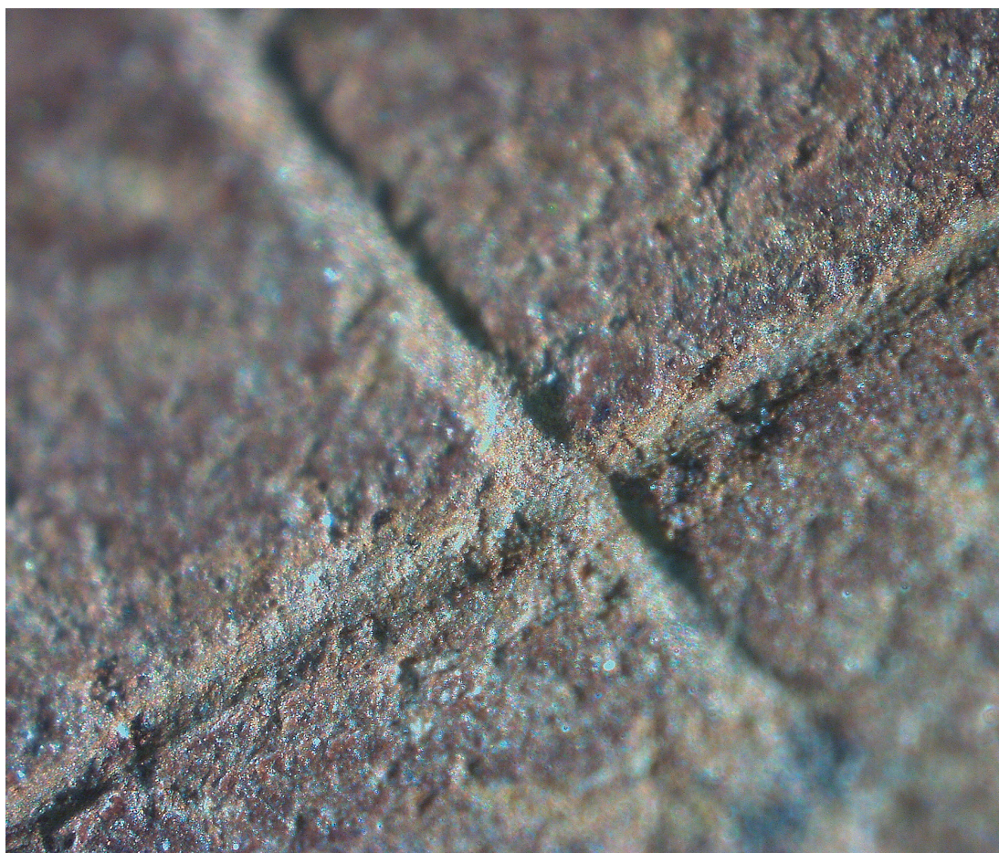
Fig.6 . Superposición de un trazo vertical sobre uno horizontal en la retícula grabada (40x). (Foto: O. Rivero).. / Superposition of a vertical line above a horizontal one in the engraved reticule (40x). (Photo: O. Rivero).
