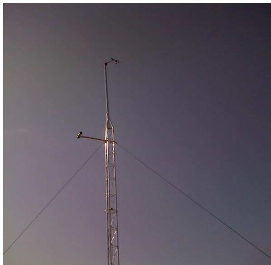
A la hora de hacer un estudio eólico, los datos de las velocidades y direcciones del viento obtenidos por el anemómetro se recogen en un chip electrónico en una pequeña computadora, registrador de datos ('data logger'), que puede funcionar con batería durante un largo período de tiempo.
