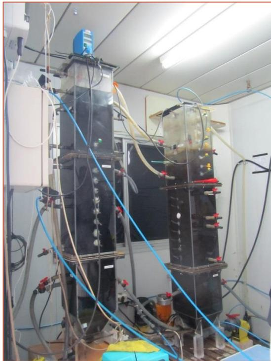
Figura 3. Reactores AnoxAn y biopelícula.
