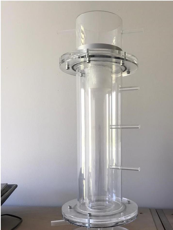
**Figura 32:** reactor UASB a escala de laboratorio, igual a los utilizados en la experimentación.
