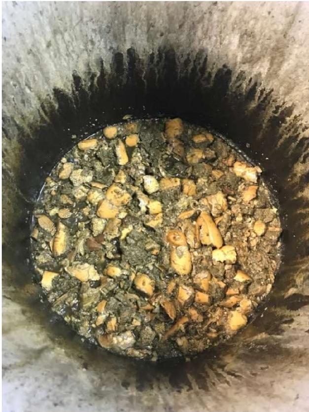
**Figura 30.** Proceso de fabricación del inóculo líquido, llenado del digester con purines bovinos y residuos de comida.
