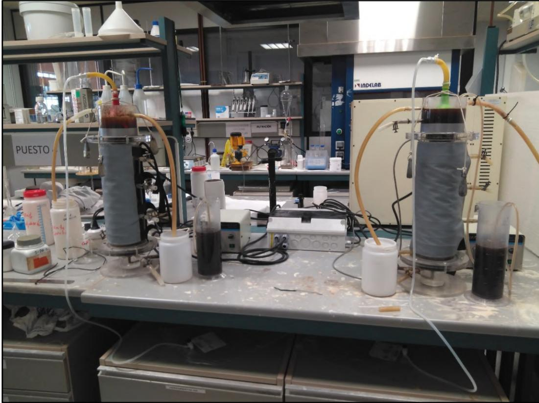
**Figura 60.** Experimentación con reactores UASB a escala de laboratorio.
