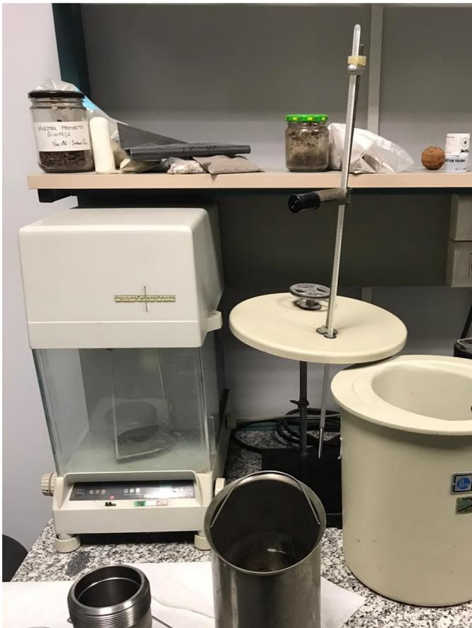
**Figura 59.** Equipo empleado en la determinación del poder calorífico de varias sustancias.
