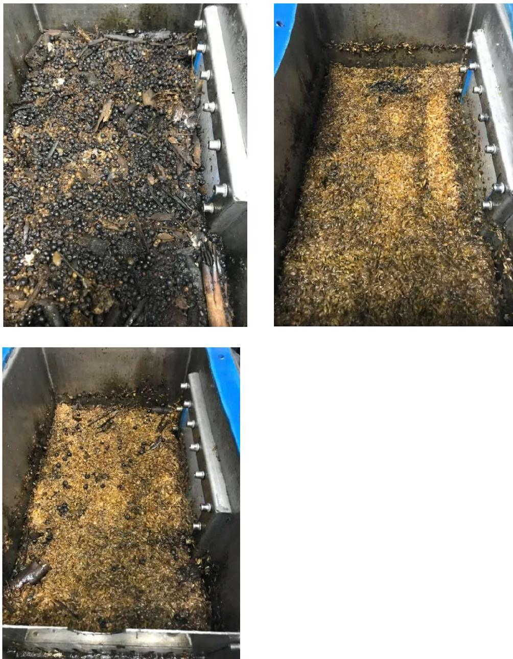
**Figura 64.** Residuos digeridos de los sustratos sólidos: DGSB (experimentos E1 y E2), BSG (E3) y mezcla de ambos (E4, 20 % DGSB, 80 % BSG)
