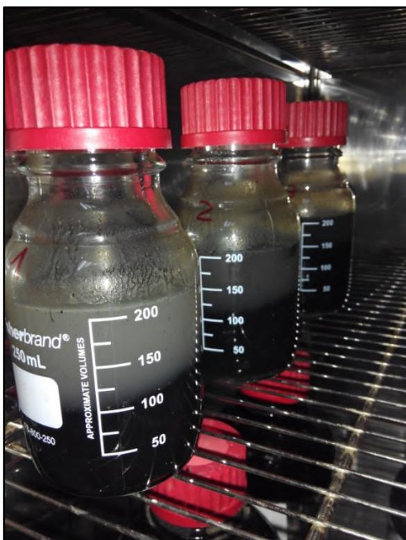
**Figura 31.** Realización de tests BMP en laboratorio.
