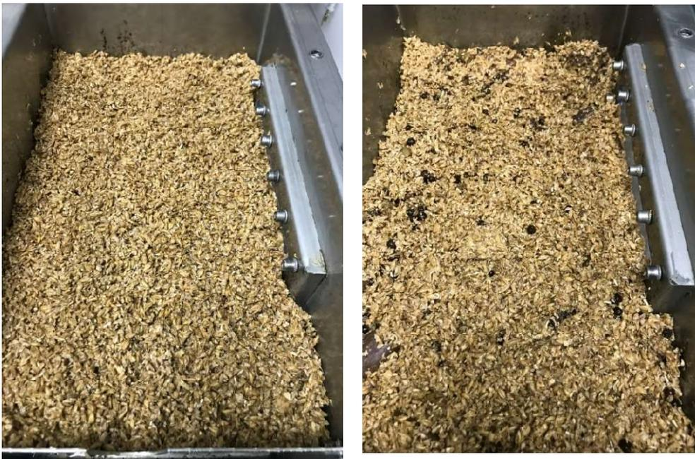
**Figura 62.** Reactores tipo caja llenos de los sustratos sólidos: DGSB (experimentos E1 y E2), BSG (E3) y mezcla de ambos (E4, 20 % DGSB, 80 % BSG).
