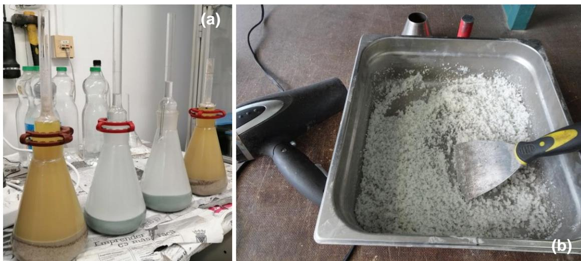
Figura 3-4. (a) Picnómetros para determinar  $\rho_a$ . (b) Equipos para determinar  $W_A$ .
