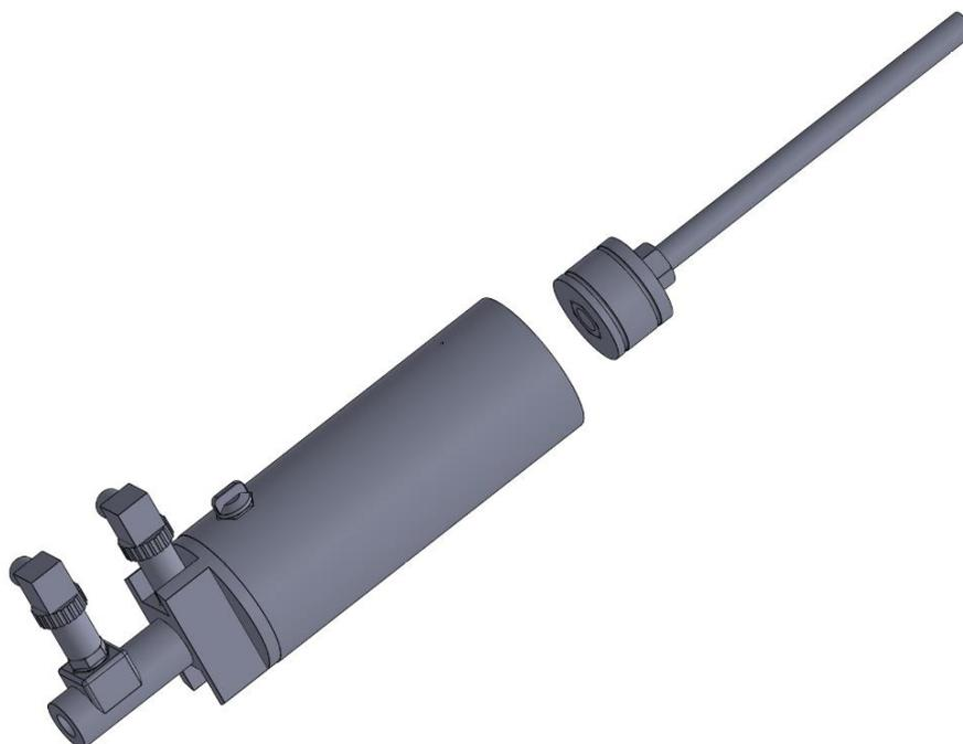
Figura A-4. Esquema tridimensional del prototipo de reómetro capilar.
