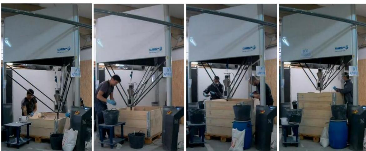
Figura 3-23. Secuencia de avance en la fabricación de los ARs.
