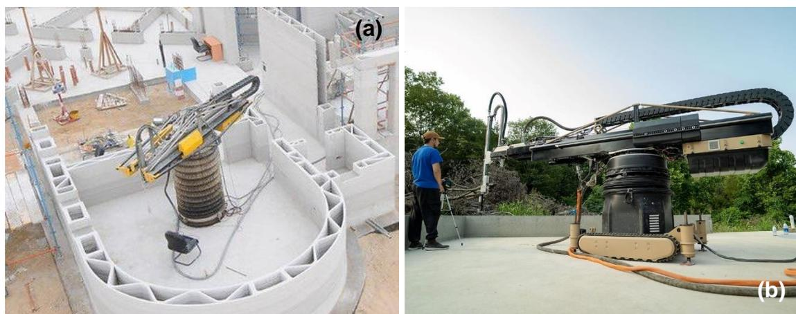
Figura 2-22. (a) Sistema polar fijo puntual. (b) Sistema polar móvil: Fuente: [Apis Cor](#).
