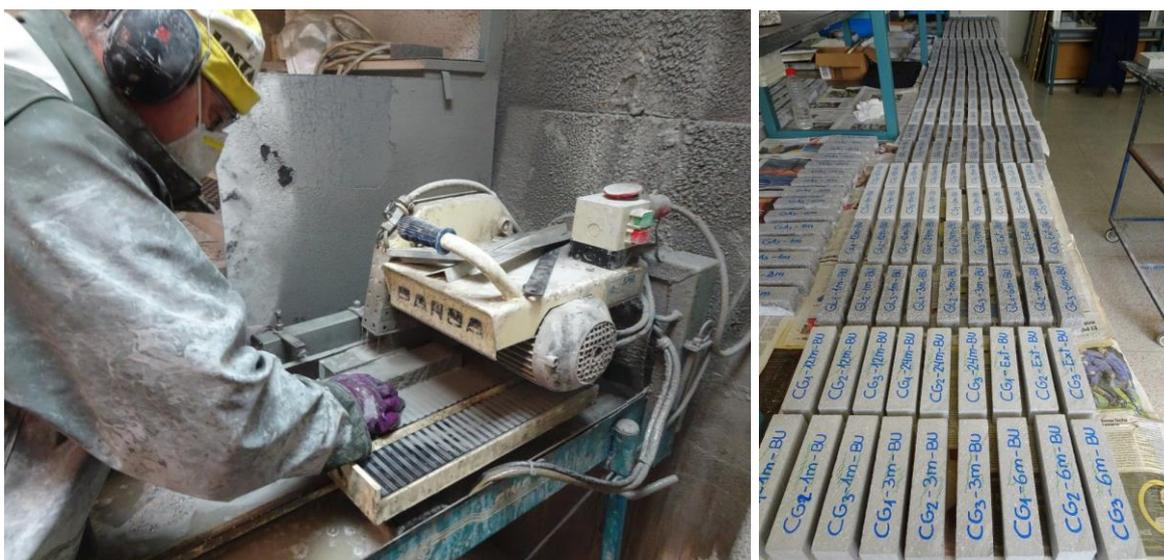
Figura 3-8. Aserrado de probetas impresas que se sumergieron en el mar.
