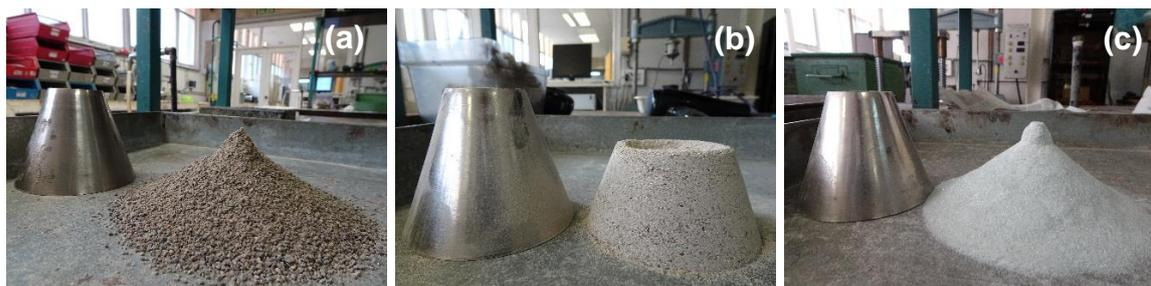
Figura 4-3. Determinación de absorción de (a) *Limestone*, (b) *Seashells* y (c) *Glass*.
