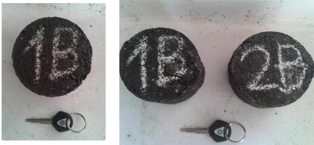
**Ilustración 47.** Probetas con vidrio reciclado antes y después de ensayo Marshall. (Laboratorio de Caminos y Aeropuertos, 2013)
