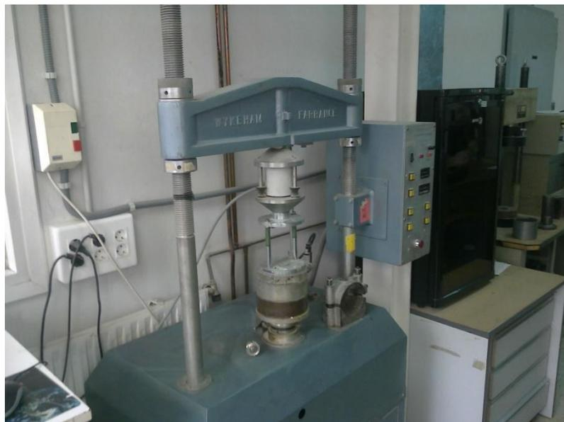
**Ilustración 50.** Prensa para rotura de probetas Marshall y sensibilidad al agua. (Laboratorio de Caminos y Aeropuertos, 2013).
