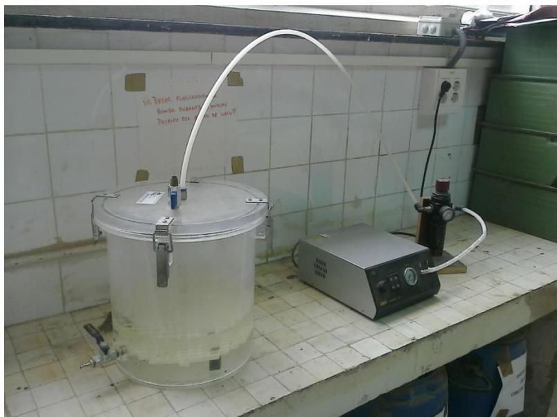
**Ilustración 48.** Cámara de vacío para probetas húmedas. (Laboratorio de Caminos y Aeropuertos, 2013).
