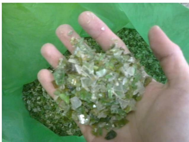
**Ilustración 25.** Vidrio reciclado procedente de planta. (Laboratorio de Caminos y Aeropuertos, 2013).
