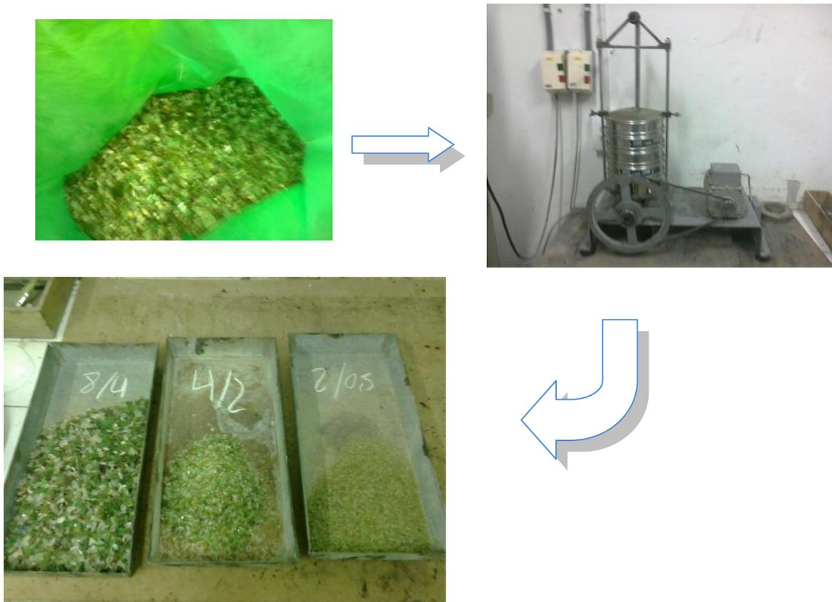
**Ilustración 44.** Fases de tamizado del material una vez llegado al laboratorio. (Laboratorio de Caminos y Aeropuertos, 2013).
