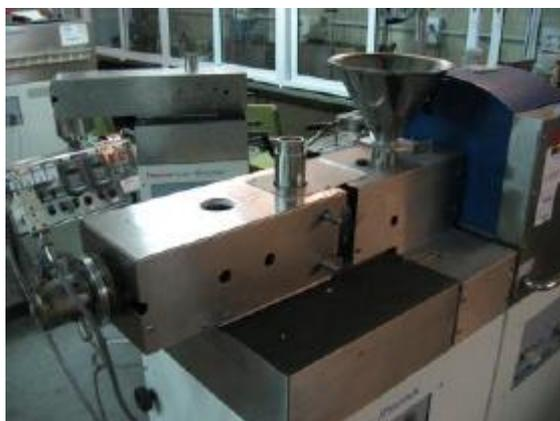
*Ilustración 20.* Extrusora de plástico reciclado. (Universidad de Huelva, 2011)
