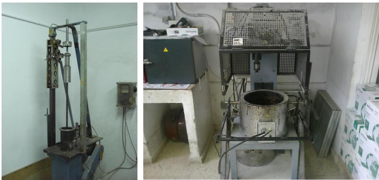
**Ilustración 45.** Compactadora y mezcladora para probetas tipo Marshall con molde en posición de compactación. (Laboratorio de Caminos y Aeropuertos, 2013).
