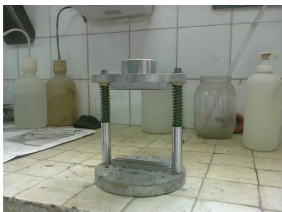
**Ilustración 49.** Mordaza para ensayo de resistencia conservada. (Laboratorio de Caminos y Aeropuertos, 2013).
