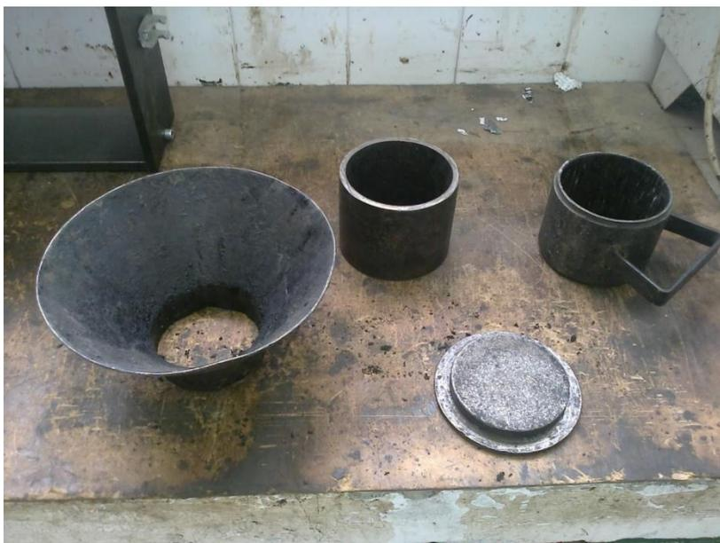
**Ilustración 46.** Embudo, cuello, molde y tapa para fabricación de probetas tipo Marshall. (Laboratorio de Caminos y Aeropuertos, 2013).
