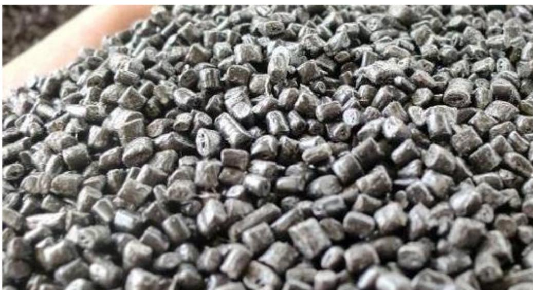
**Ilustración 18.** Residuos plásticos después de tratamiento de extrusionado y balanceado.
