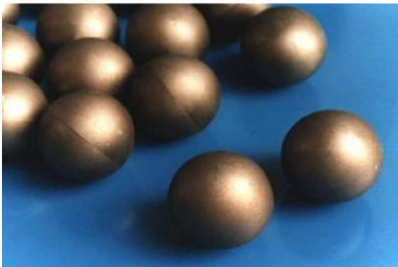
Figura 3.11: Elementos combustibles del HTR-PM (Fuente: ARIS)
