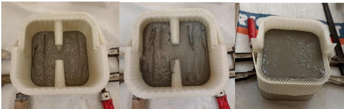
*Figura 65: Proceso de llenado del molde*
