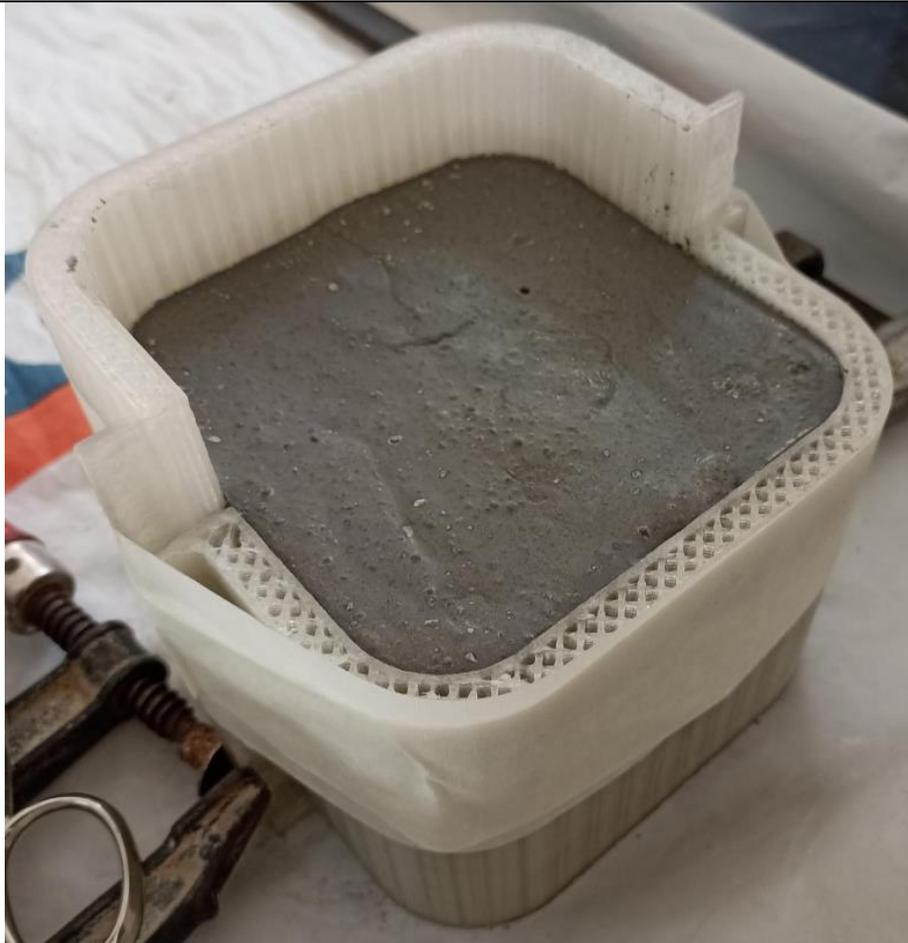
*Figura 66: Mortero completamente fraguado*
