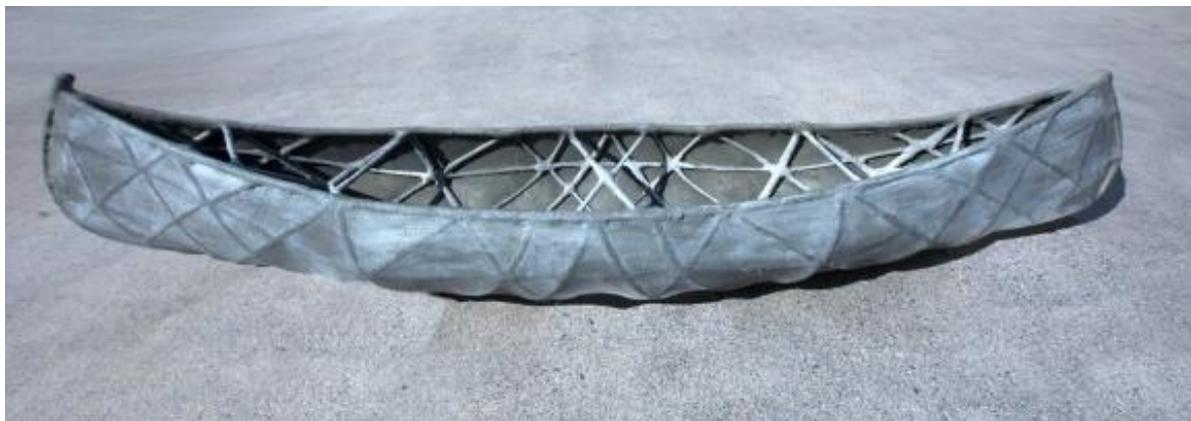
*Figura 21. Canoa fabricada con hormigón (Jipa, 2017).*
