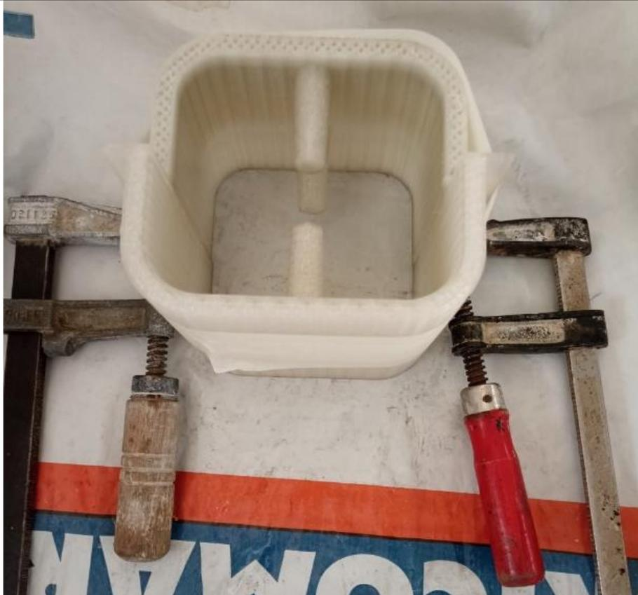
*Figura 64: Sujeción de las paredes del molde*
