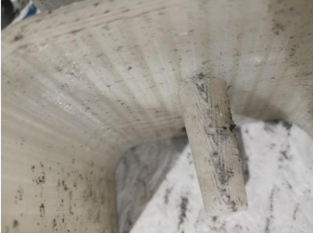
*Figura 69: Adherencia del mortero y los machos*
