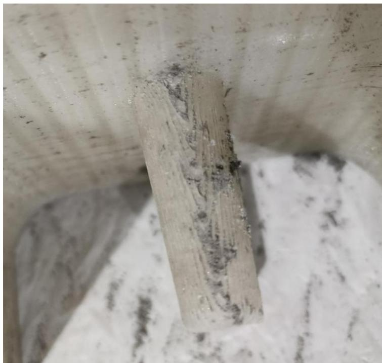
*Figura 79: Macho del molde con restos de mortero*
