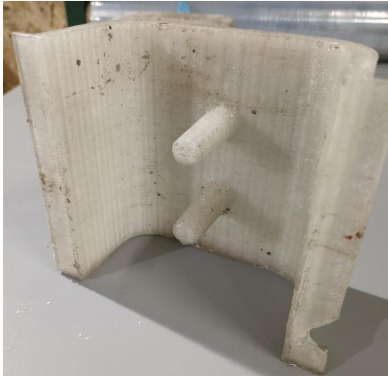
*Figura 75: Primeros defectos sobre el molde*
