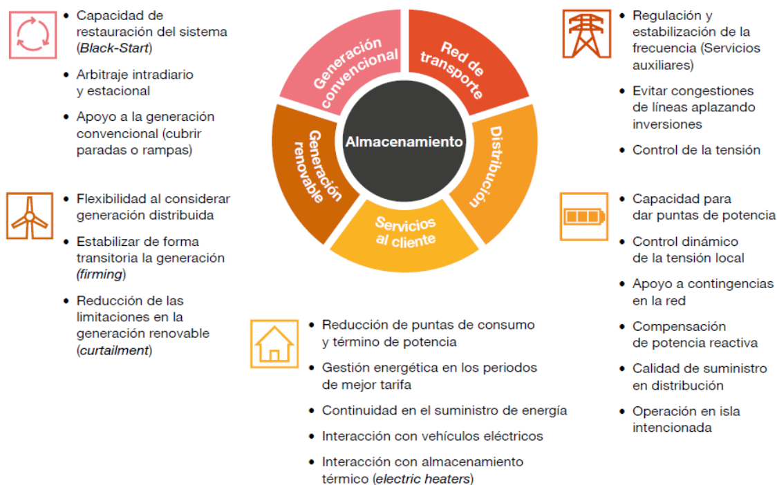
Figura 3 Servicios de red que ofrecen los SAE. Fuente: "El papel del almacenamiento en la Transición Energética", Fundación Naturgy y PricewaterhouseCoopers Asesores de Negocios, S.L.
