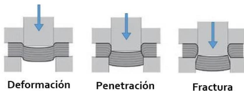
Figura 2 – Etapas simplificadas del proceso de punzonado, MIPSA.
