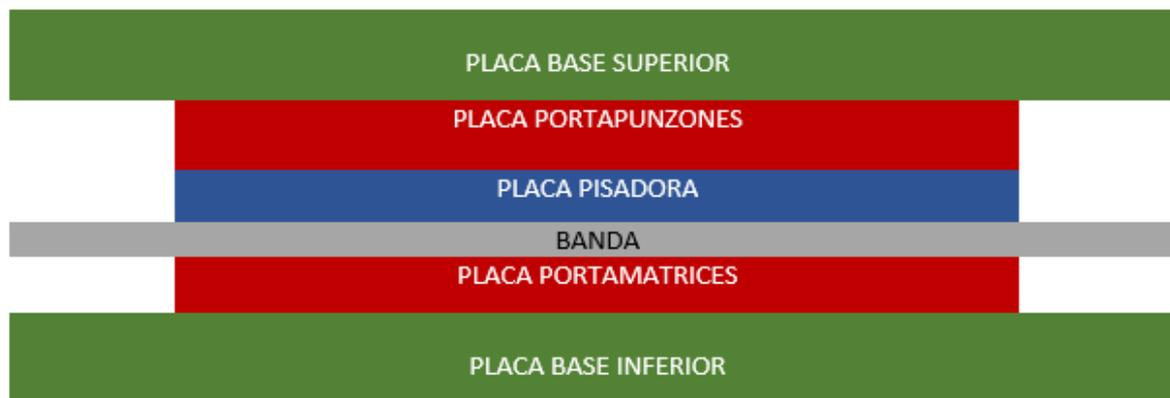
Figura 54 – Esquema de las partes de un troquel
