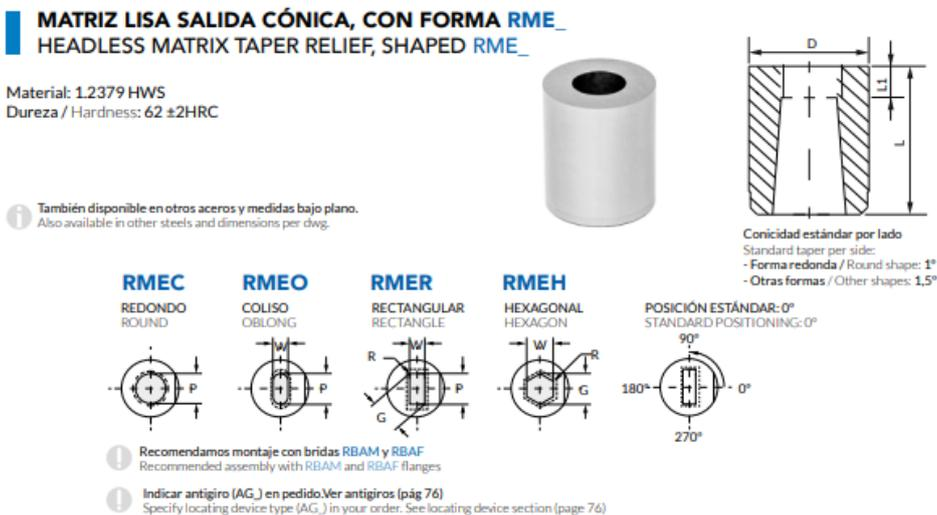
Figura 71 – Modelo de matriz RMEC para el punzonado de 2 mm. Catálogo ROYME (2021).
