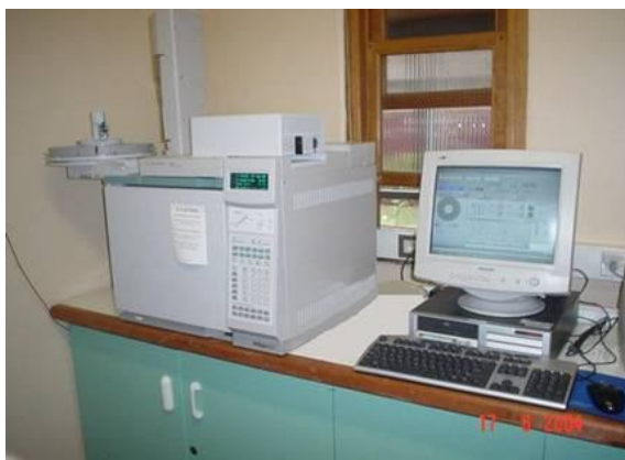
Figura 18. Fotografía de un cromatógrafo de gases modelo 6890N (Agilent Technologies)
