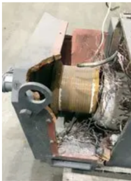
Figura 8: Fallo catastrófico de un motor de corriente alterna por desprendimiento de las barras del conmutador debido a la fuerza centrífuga (Horner Industrial Group, 2019)
