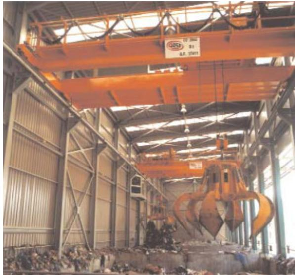
***Figura 8. Pulpos de carga de los RSU (Urbaser, 2006).***
