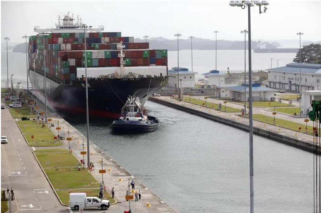
Ilustración 16: Buque *Neopanamax* sin uso de locomotoras y uso de remolcadores. Fuente: Última hora “2017”
