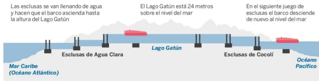
Ilustración 4: Esclusas Neopanamáx. Fuente: Lampadia "La ampliación del Canal de Panamá"
