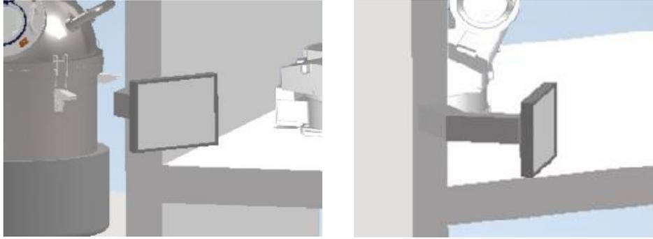
*Vista en detalle de la pantalla en la que se configuran todos los parámetros.*
