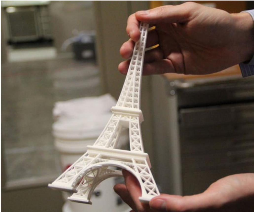
*Miniatura de la Torre Eiffel imprimida con una impresora 3D [30].*
