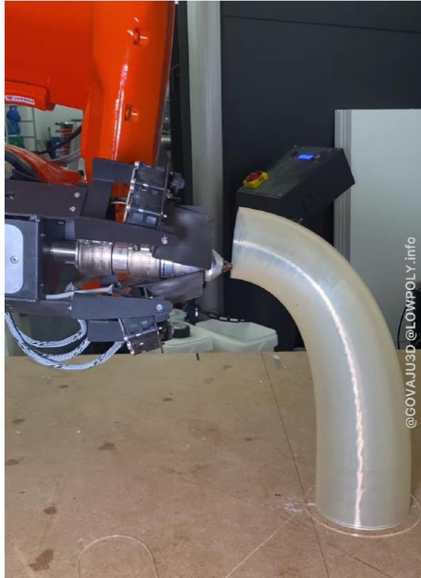
*Impresión en 3D a 90° mediante brazo robótico [51].*
