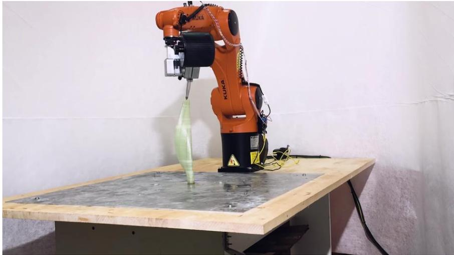
*Vista general del brazo robótico imprimiendo el modelo [52].*
