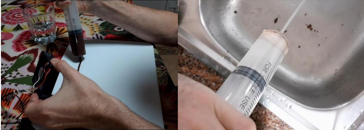
*Extrusión del material con enfriado de un ventilador y limpieza satisfactoria del inyector con agua caliente.*
