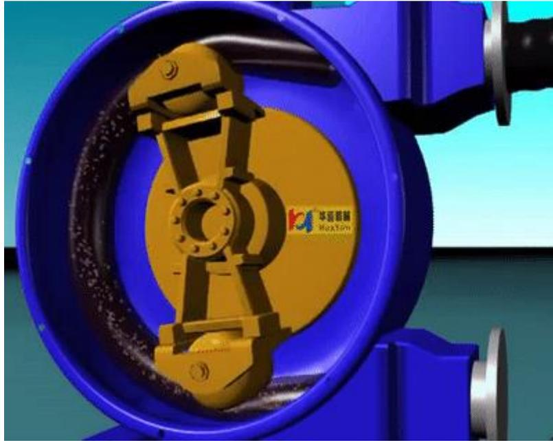
*Ilustración del funcionamiento de una bomba peristáltica [57].*
