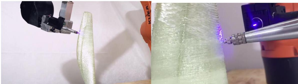
*Vistas en detalle de la extrusión del brazo robótico. Se aprecia la extrusión sobre las caras exteriores [52].*
