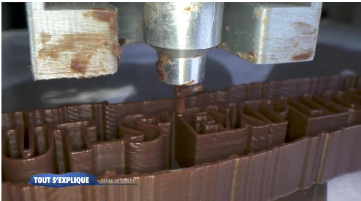
*Detalle del extrusor de la impresora 3D utilizada por Miam Factory [50].*
