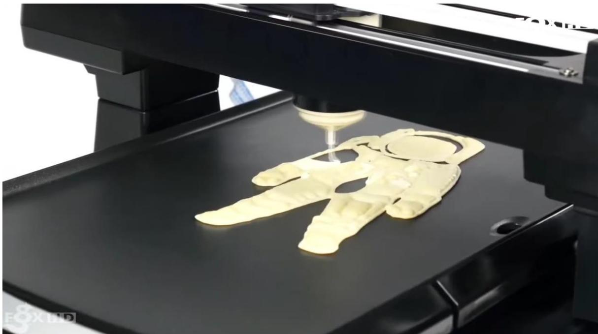
*Máquina capaz de imprimir masa de tortitas sobre la plancha que las cocina [40].*
