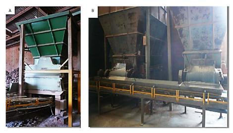
Figure 2.27. Equipment of the Company Reciclados de Cabezon: A) Shredder; B) Feeder.
