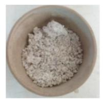
Figure 3.4. Si-CaCO<sub>3</sub>-Ca(OH)<sub>2</sub> Sludge.
