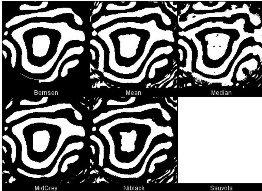
Figura 4.10. Efecto de aplicar diferentes técnicas de umbralización local al interferograma de una aberración aleatoria. De izquierda a derecha y arriba abajo: Bernsen, Mean, Median, MidGrey, Niblack y Sauvola.
