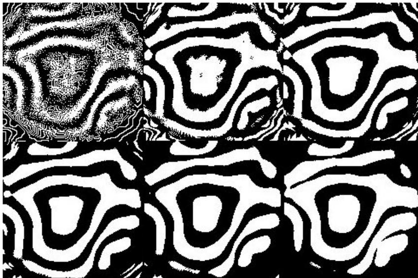
Figura 4.11. Efecto de aplicar el umbral local “Mean” con diferentes radios. De izquierda a derecha y de arriba abajo: 1, 5, 10, 15, 25 y 50 píxeles respectivamente.
