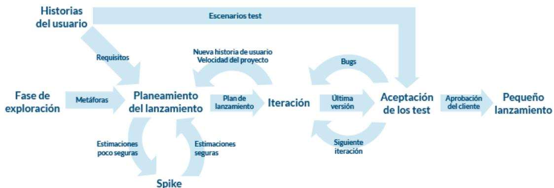
**Figura 3.3 Método Extreme Programming**
