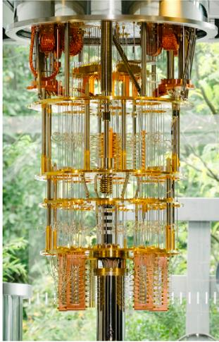
**Figura 2.2:** IBM 5Q System. Criostato de un ordenador de IBM con 50 qubitss superconductores.
