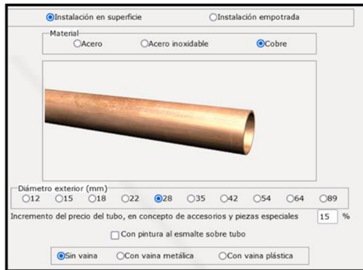
Figura 31 Cálculo precio tuberías con CYPE Ingenieros. Fuente: http://www.generadordeprecios.info/
