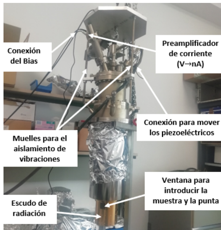
Figura 2.1: Imagen del STM en el laboratorio donde se indican sus componentes principales.
