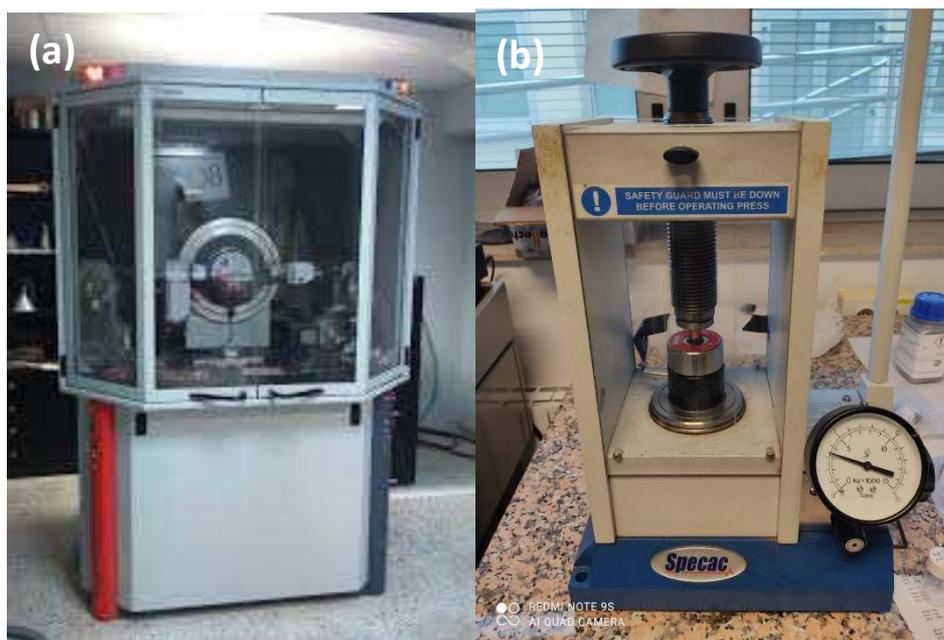
Figura 11. (a) Difractómetro D8 empleado [17]. (b) Prensa hidráulica de laboratorio para la realización de pastillas.
