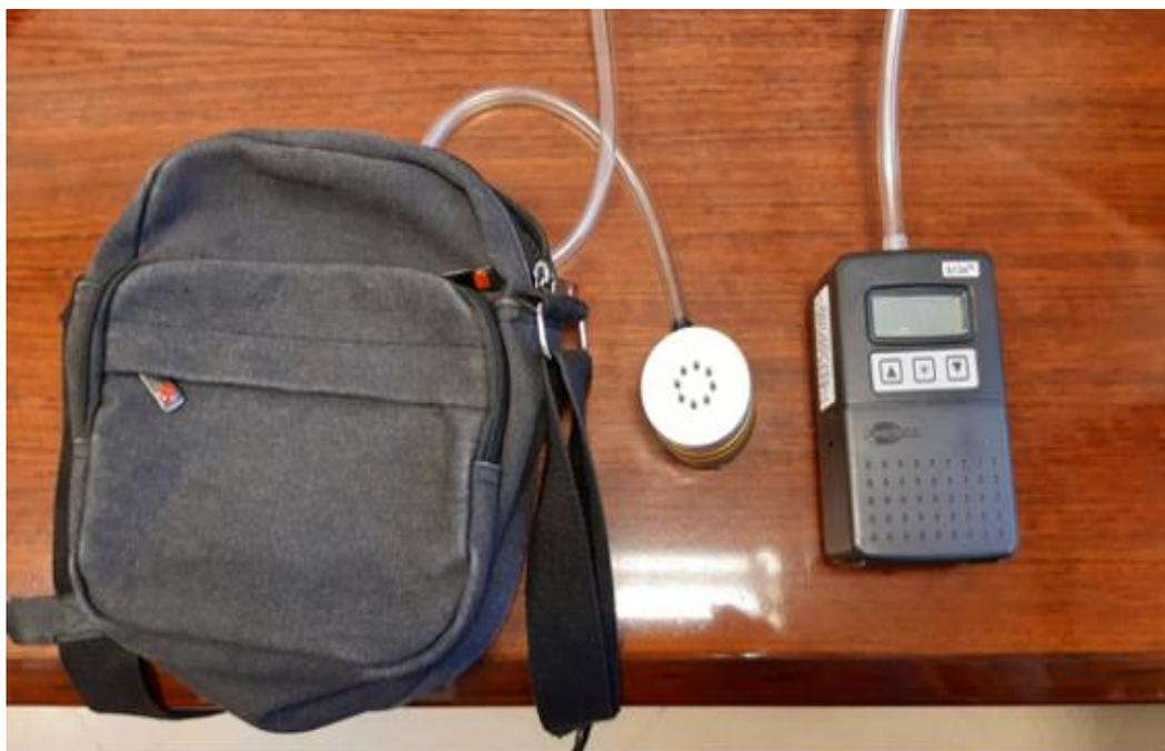
**Figura 3.** Muestreador de bioaerosoles basado en filtración con bomba portátil.
