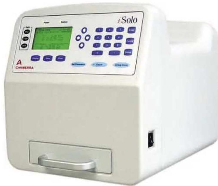
Figura 37: Contador alfa-beta iSolo.
