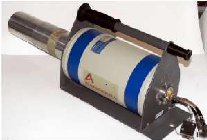
Figura 36: Detector de semiconductores para la espectroscopía de rayos gamma, HPGe con criostato LN2.
