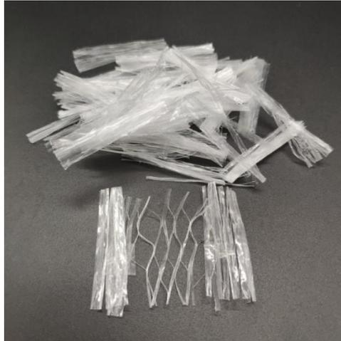
Ilustración 9.13: Malla fibrilada de polipropileno. Fuente: Amhui Elite, 2021.
