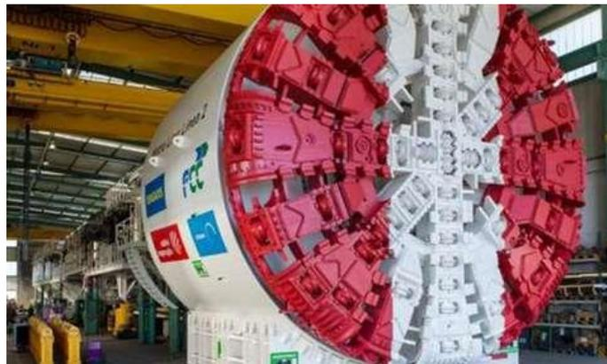
*Ilustración 5.9: Tuneladora tipo topo. Fuente: Peters, 2021.*
