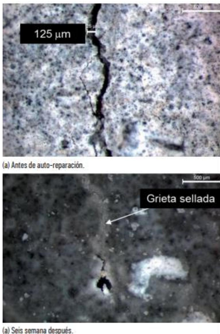
*Ilustración 10.9: Fases de reparación de las grietas del canal de Tungurahua (Ecuador). Fuente: Sierra, Mera y Jonkers, 2015.*
