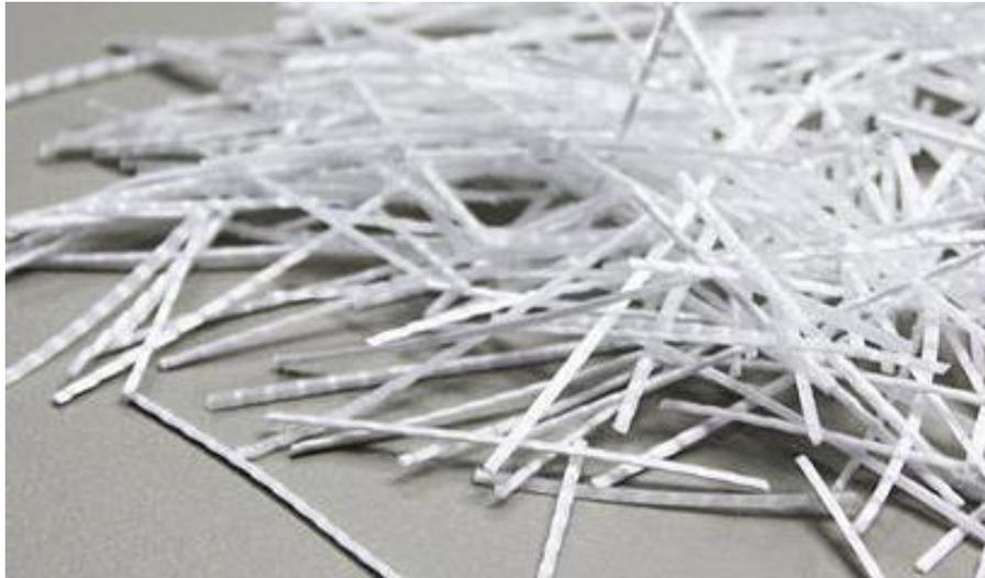
Ilustración 9.28: Fibras de polipropileno. Fuente: Structuralia, 2022.
