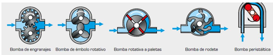
*Ilustración 6.26: Ejemplos de bombas de desplazamiento positivo rotatorias. Fuente: Domínguez, 2022.*
