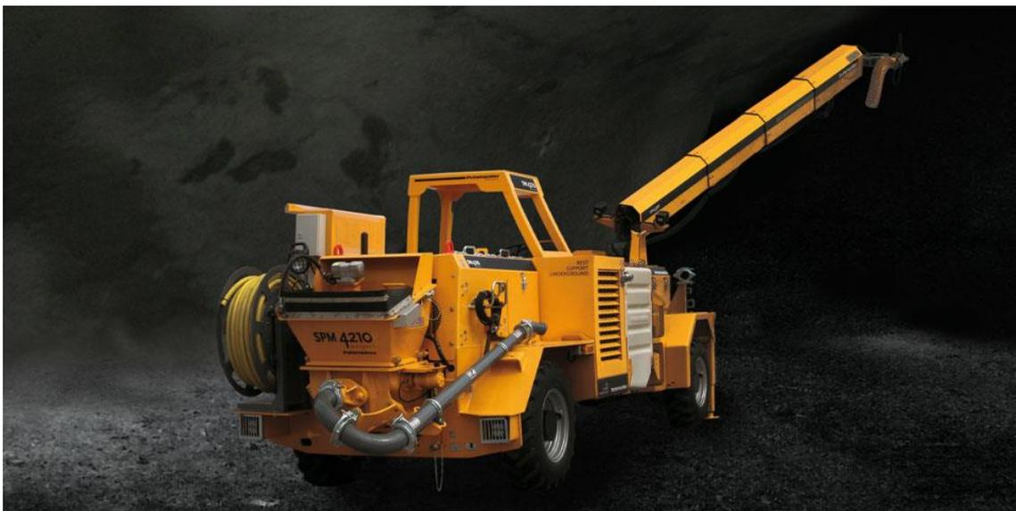
*Ilustración 6.28: Equipo robotizado para hormigón proyectado. Fuente: Putzmeister, 2015.*
