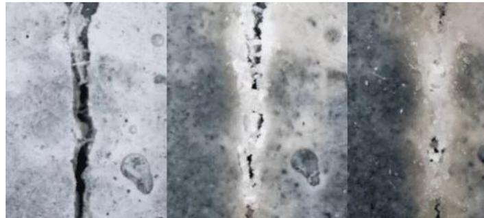
Ilustración 10.6: Autorreparación del hormigón por fases (Universidad de Delft). Fuente: Inarquia, 2016.
