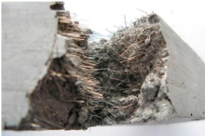
*Ilustración 9.9: Hormigón con fibras de carbono. Fuente: Yepes Piqueras, 2016.*
