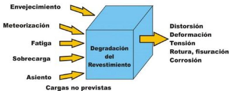
Ilustración 8.5: Consecuencias de la degradación del revestimiento de hormigón. Fuente: Cornejo Álvarez, 2014.
