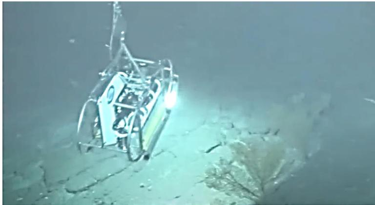
Figura 3.23. ROTV Politolana operando sobre un fondo a 550 metros de profundidad.
