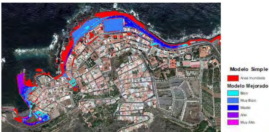
Figura 19. Comparación de los resultados de inundación del modelo simple y el modelo modificado. Histórico  $T_r=50$ . Fuente. Propia
