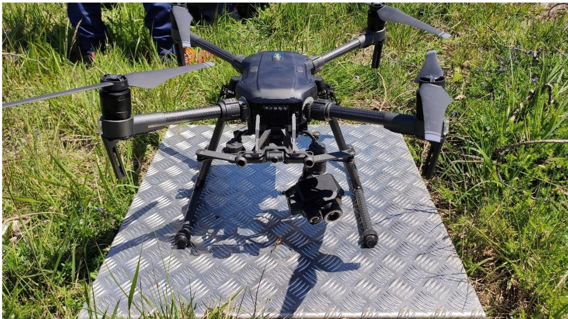
*Ilustración 44.- Dron UAV DJI Matrice 210 V2 con cámara Zenmuse XT2.*
