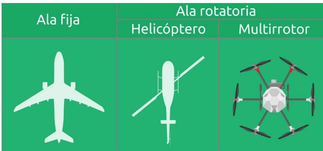
*Ilustración 11.- Tipos de dron.*
