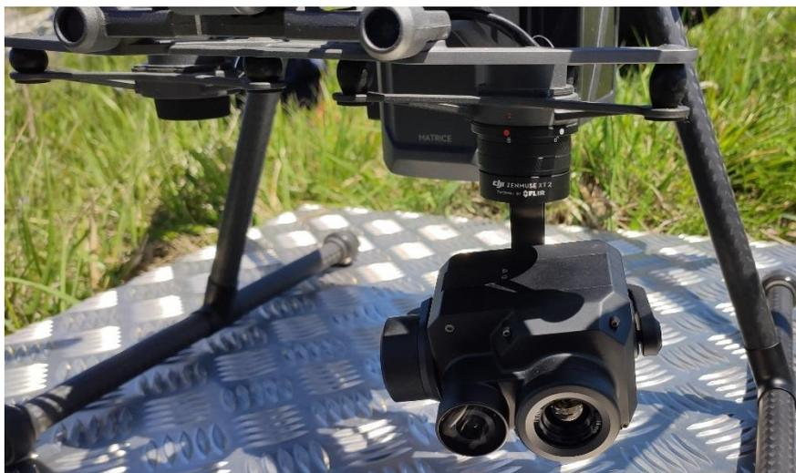
*Ilustración 45.- Sensor radiométrico Zenmuse XT2.*
