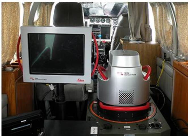
Ilustración 27.- Cámara fotogramétrica Leica ADS80
