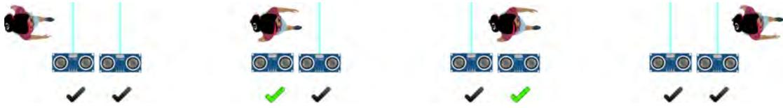
Figura 10.3: Funcionamiento del cuentapersonas mediante sensores HCSR04.
