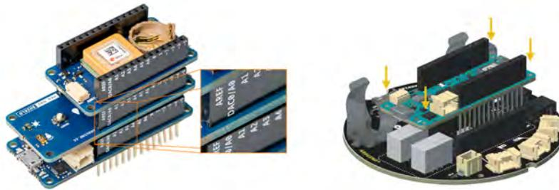
Figura 9.8: Montaje de Arduino MKR con protectores y soporte [39], [40].
