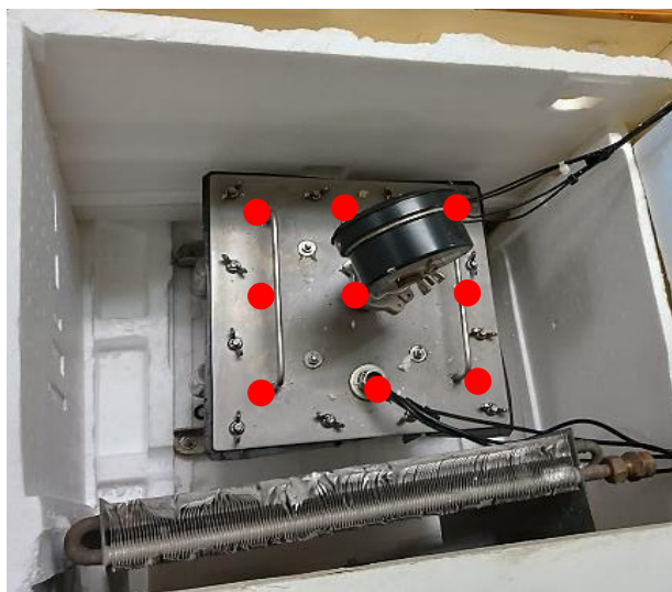
Ilustración 32. Puntos de toma de velocidad de flujo de aire sobre la superficie superior de la cuba - Fuente: El autor
