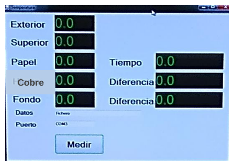
Ilustración 34. Interfaz de usuario para la visualización de los registros de temperaturas captados con el sistema de adquisición de datos - Fuente: El autor
