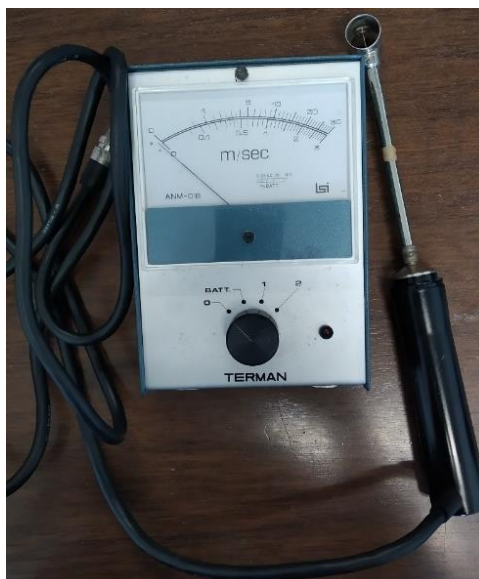
Ilustración 31. Anemómetro de hilo caliente empleado para la medición de velocidad de flujo de aire en el interior del cajón - Fuente: El autor
