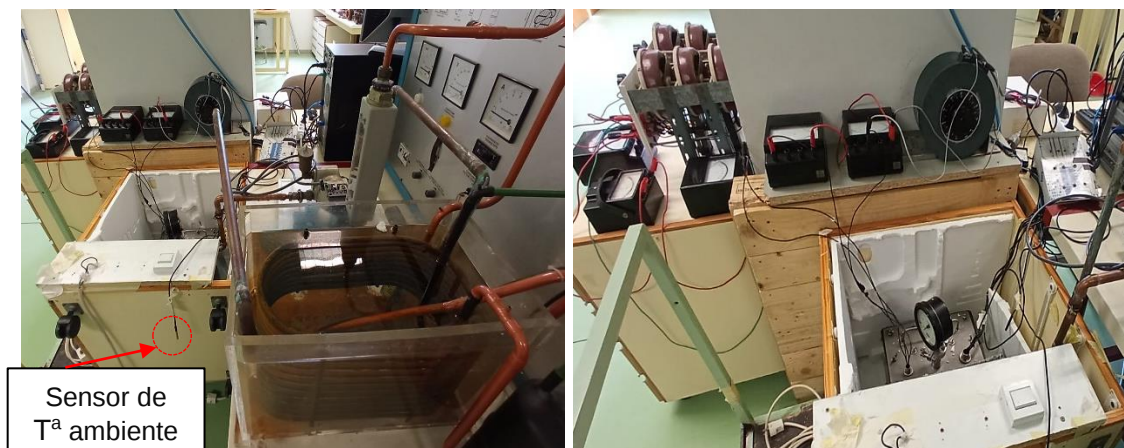
Ilustración 29. Instalación térmica y eléctrica para los ensayos - Fuente: El autor
