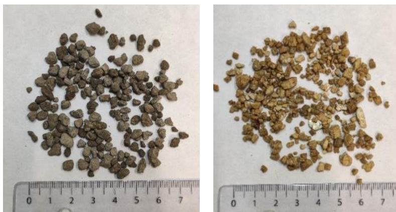
Figura 20. Detalle de las cápsulas con rejuvenecedor puro: sepiolitas (izda) y vermiculitas (dcha)
