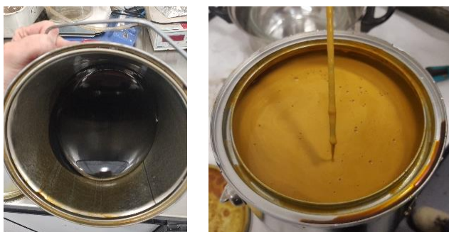
Figura 9. Rejuvenecedor puro (izda.) y en formato emulsión (dcha.)
