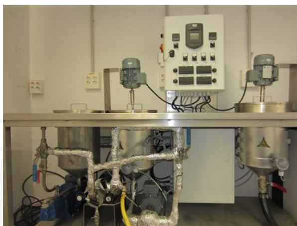
Figura 3. Planta de laboratorio de modificación de betunes
