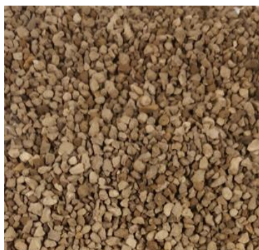
Figura 21. Detalle de las cápsulas de sepiolita con rejuvenecedor en formato emulsión
