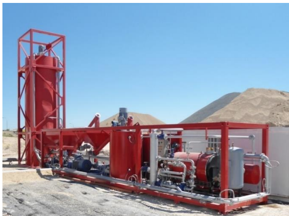
Figura 37. Planta de modificación de betunes a escala industrial
