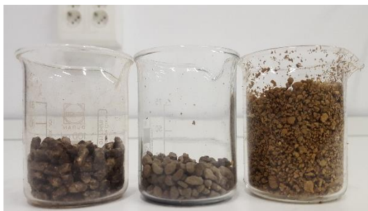
Figura 29. Diferencia en volumen de las cápsulas de sepiolita (centro), frente a las vermiculitas (dcha) y las fibras (izda) para un peso determinado.
