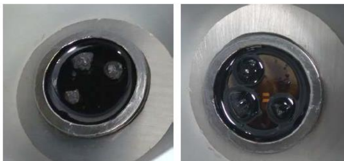
Figura 50. Detalle del aspecto del grado de difusión antes (izda.) y después (dcha.) del ensayo
