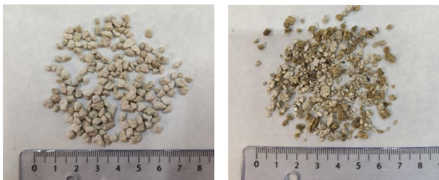
Figura 11. Detalle de los áridos porosos: sepiolita (izda), vermiculita (dcha)
