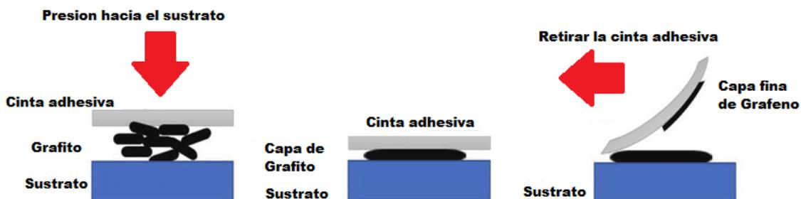
Figura 7 - Exfoliación mecánica mediante cinta adhesiva
