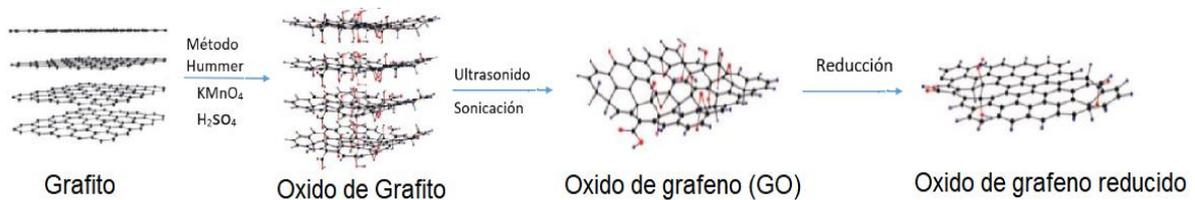
Figura 10 - Obtención del Grafeno mediante Hummers[7]
