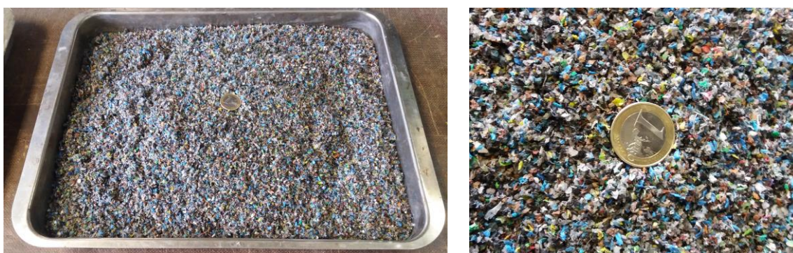
Foto 3.8: Plásticos procedentes del pelado de cables de cobre
