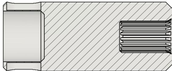
Figura 10: Modelo 1, sección del árbol de transmisión.
