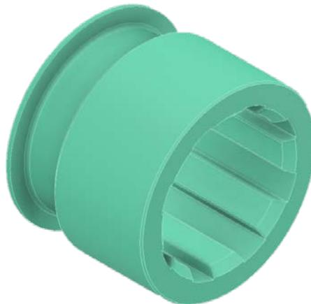
*Figura 28: Polea ranurada para la conexión con el modelo 3.*
