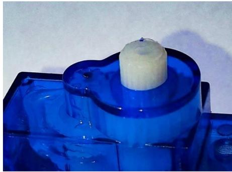
Ilustración 27. Detalle de la corona dentada del micro servo
