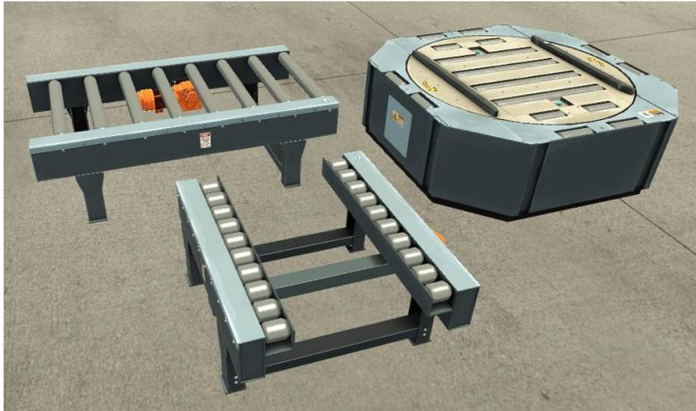
**Figura 16.** Elementos de carga pesada Factory I/O (cinta de rodillo, placa giratoria y transportador de carga)
