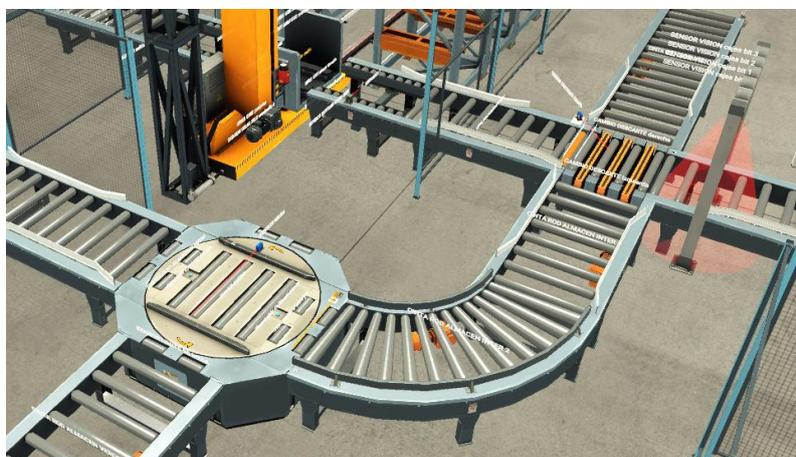
**Figura 28.** Clasificador de cajas para almacenamiento
