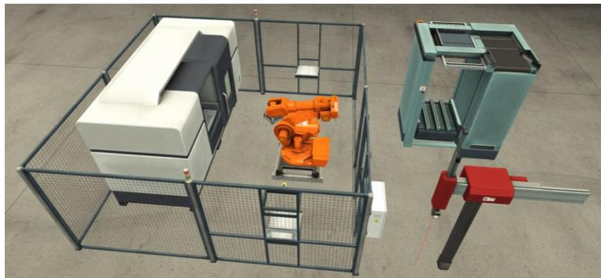
**Figura 19.** Estaciones Factory I/O (centro de mecanizado, paletizadora y pick and place)
