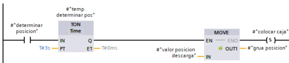
Figura 47. Empleo de la función MOVE para el posicionamiento de la grúa
