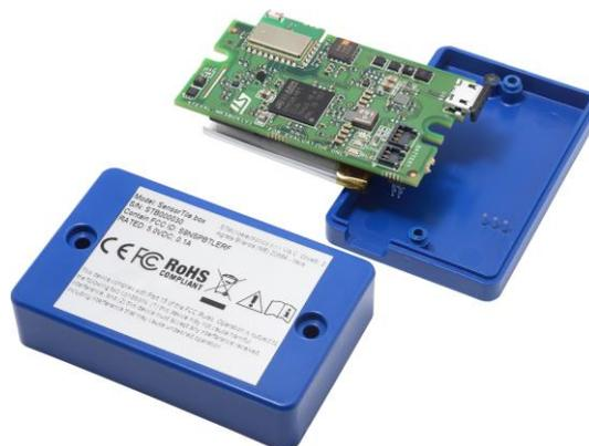
Ilustración 8. SensorTile.box. Placa y caja del sensor
