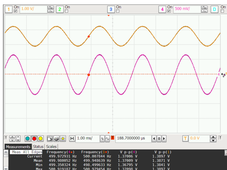
Fig. 3.24. Medida de señales de entrada y salida para la frecuencia superior de operación en el bloque elevador de tensión del prototipo 03.
