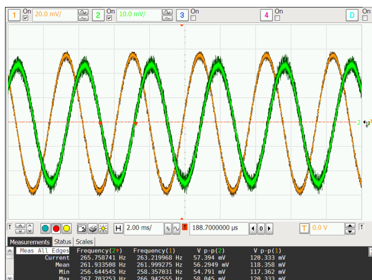
Fig. 3.15. Medida de señales de entrada y salida en el punto de atenuación 6 dB para el FPB del prototipo 03.
