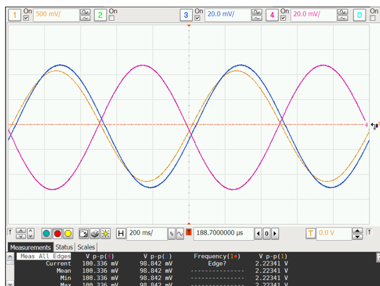
Fig. 3.11. Medida de señales de entrada y salida a 2 Hz para el bloque de amplificación diferencial del prototipo 03.
