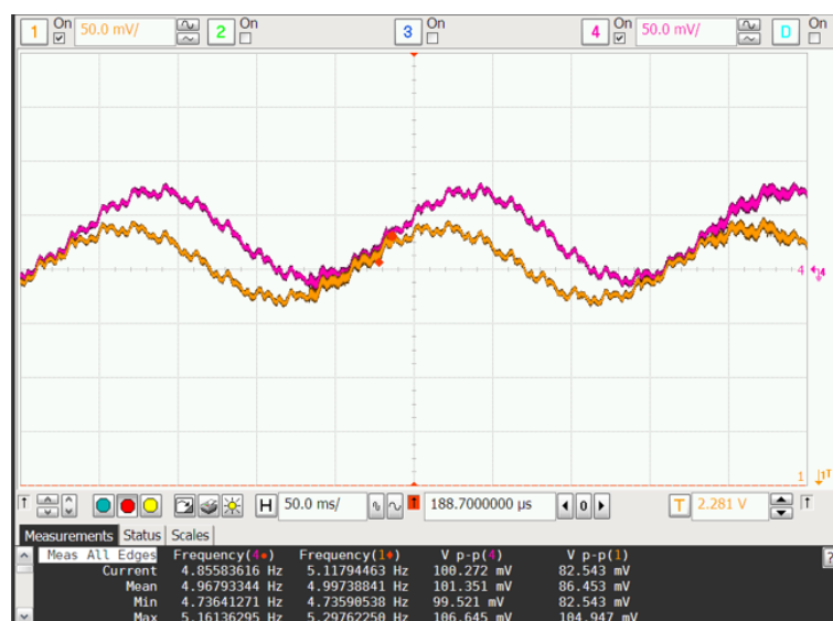
Fig. 3.23. Medida de señales de entrada y salida para la frecuencia inferior de operación en el bloque elevador de tensión del prototipo 03.
