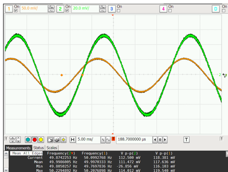
Fig. 3.13. Medida de señales de entrada y salida a 50 Hz para el FPB del prototipo 03.
