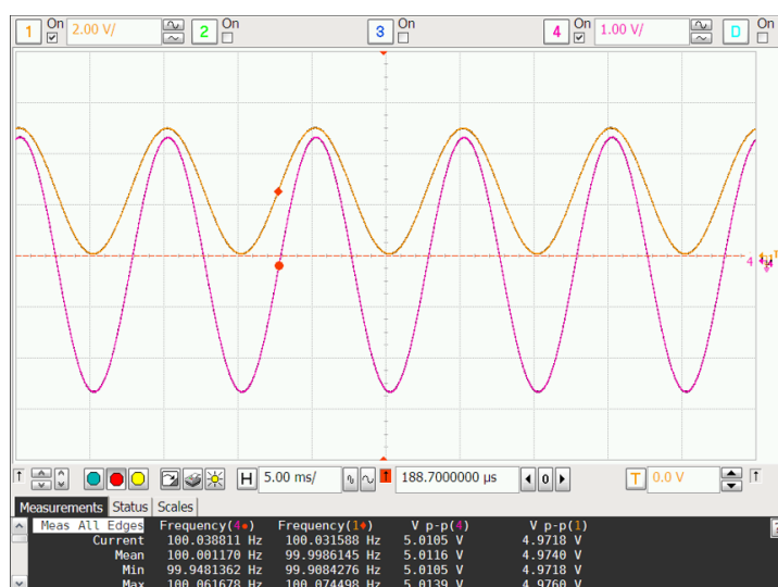
Fig. 3.22. Medida de señales de entrada y salida a 100 Hz para el bloque elevador de tensión del prototipo 03.
