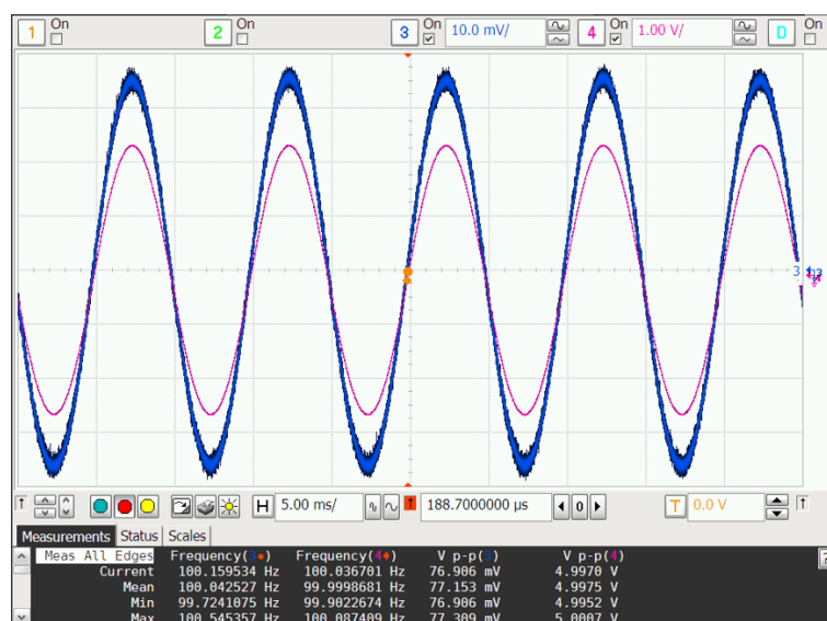
Fig. 3.19. Medida de señales de entrada y salida a 100 Hz para el amplificador de tensión del prototipo 03.
