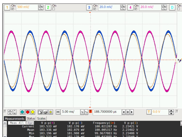
Fig. 3.10. Medida de señales de entrada y salida a 100 Hz para el bloque de amplificación diferencial del prototipo 03.
