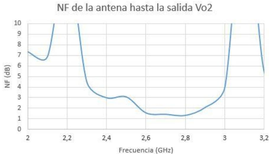
Figura 40. Figure de ruido desde la entrada de la antena a la salida Vo2 del radiómetro.
