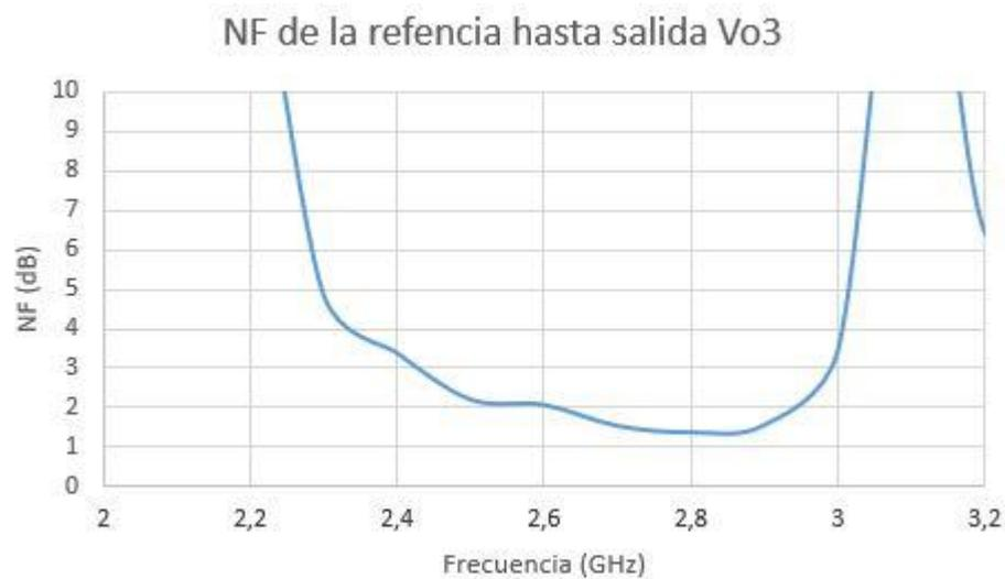
Figura 39. Figura de ruido desde la entrada de la referencia a la salida Vo3 del radiómetro.
