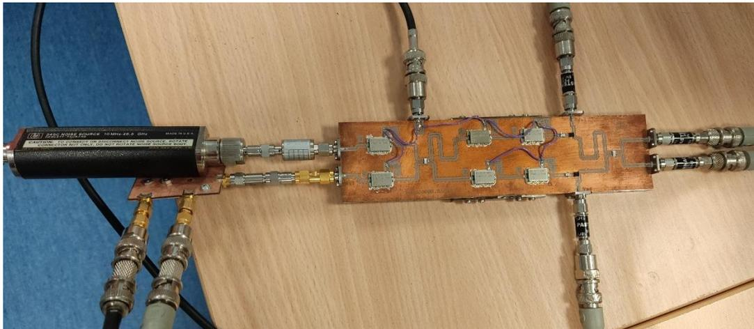
Figura 48. Conexión de la fuente de ruido 346C con atenuador de 13dB y la fuente de ruido NC520 Noisecom.
