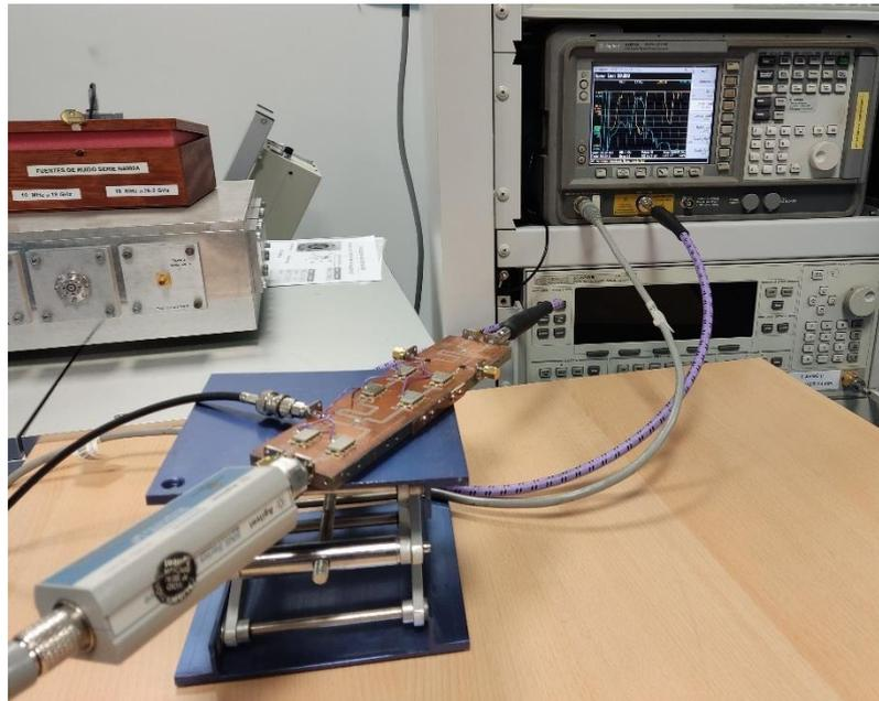
Figura 38. Conexión del radiómetro al equipo NFA Series Noise Figure Analyzer N8975A.
