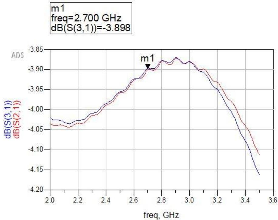
Figura 12. Equilibrio en la amplitud del divisor de potencia.
