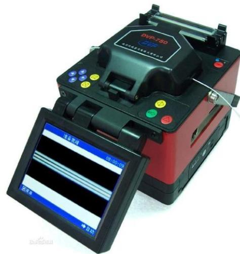
Figura 48. Equipo fusionador de fibra de última generación
