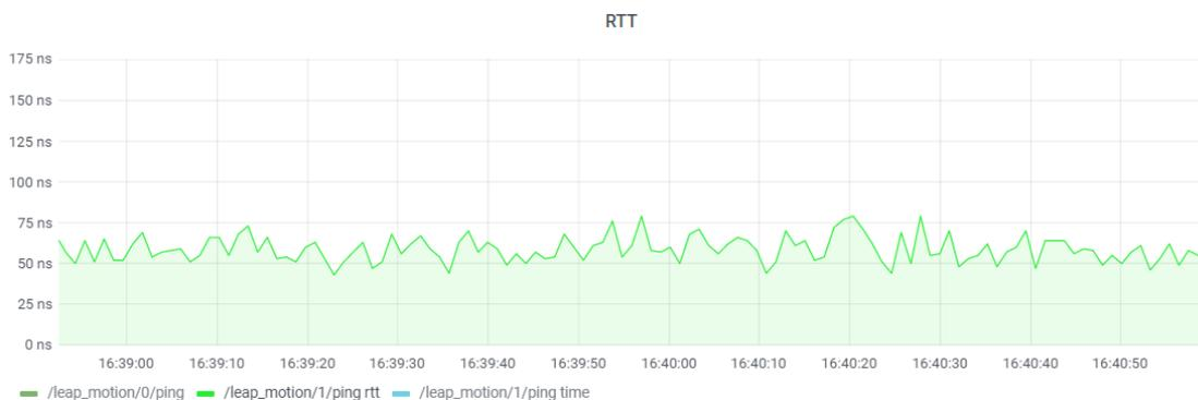
Figura 3.5. Muestra de datos obtenidos en tiempo real con una conexión MQTT, en un intervalo de dos minutos, vista con la herramienta *Grafana*. Elaboración propia.
