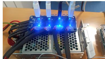
(d) Montaje de PCB de interfaces de alimentación USB conectada a la fuente
